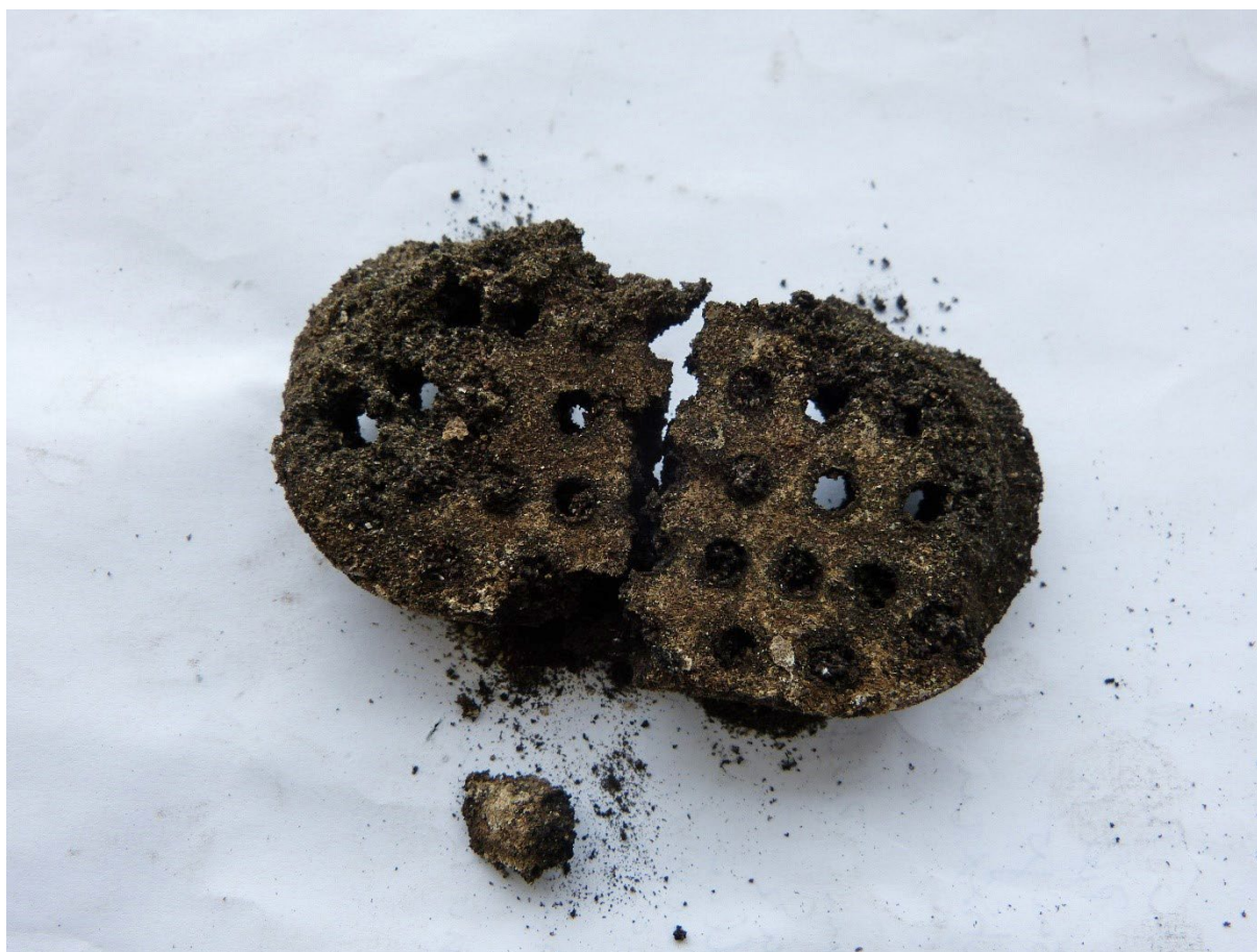
Abbildung 197: Versinterte Rostasche nach 24-h-Betrieb mit Sortiment 24 der marktverfügbaren Holzpellets in Pelletofen 2
