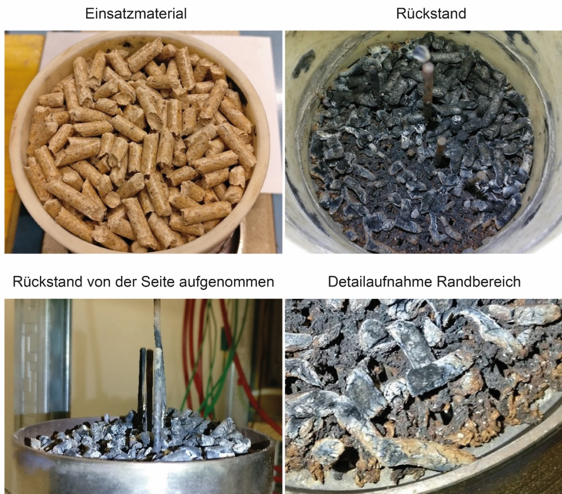
Abbildung 241: Bilder des Einsatzmaterials und der Rückstände beim Testlauf mit Pelletsortiment 17 und AK-3
