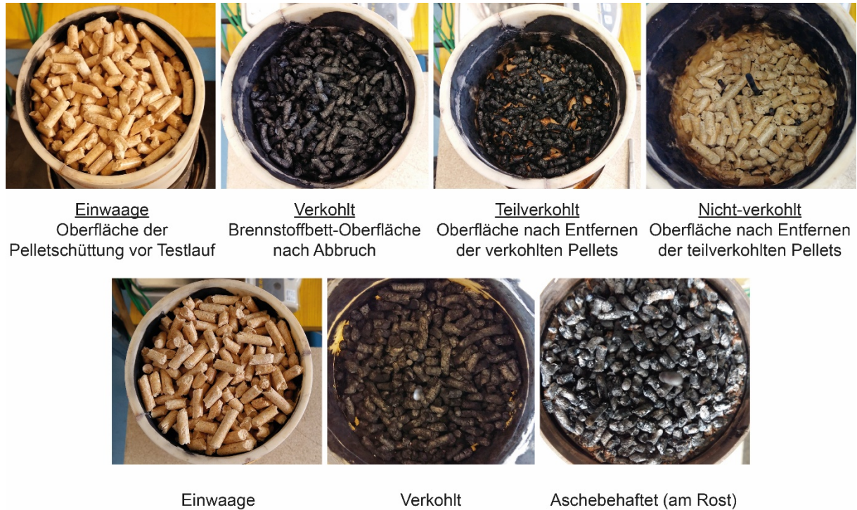
Abbildung 239: Laborreaktorversuche mit Reaktionsabbruch – Brennstoffbettbewertung am Beispiel Fichtenpellets (oben: AK-1, unten: AK-2)
