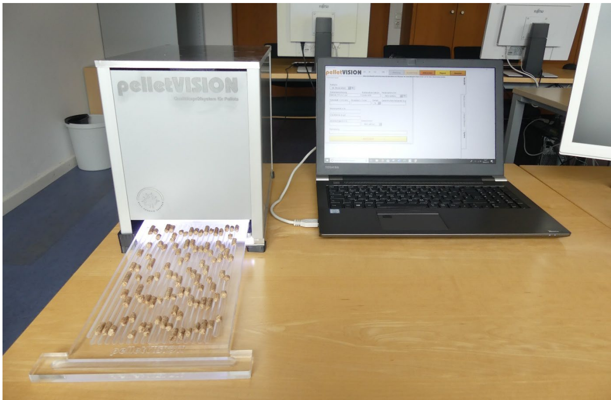
Abbildung 12: Versuchsaufbau pelletVISION zur Schnellbestimmung der Pelletlänge
