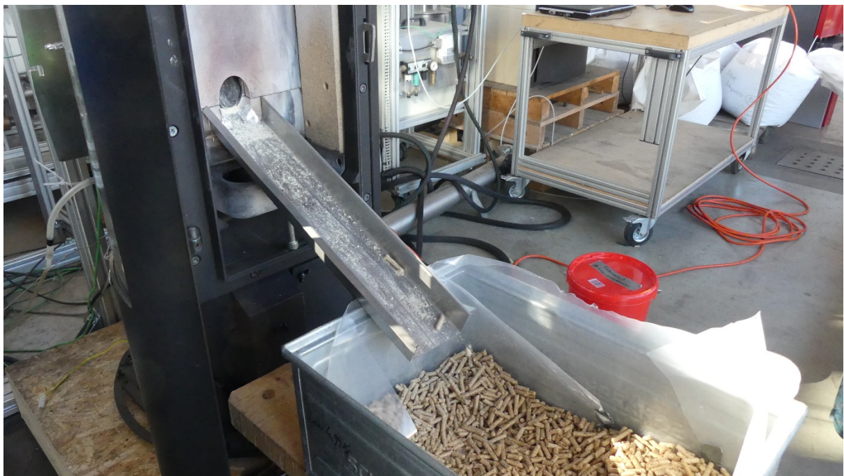
Abbildung 24: Versuchsaufbau zur Durchführung der Förderversuche am kalten Pelletofen
