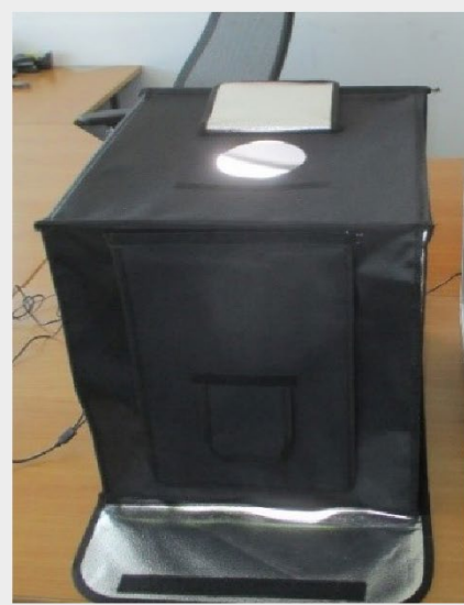
Geschlossene Fotobox. Durch die Öffnung an der Oberseite wurden die Probenfotos aufgenommen.
