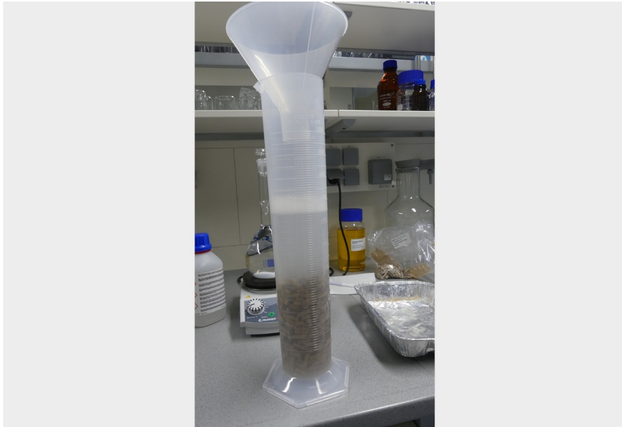
Abbildung 11: Versuchsaufbau der Partikeldichtemessung im Messzylinder als Schnellbestimmungsmethode nach der Zugabe von Pellets
