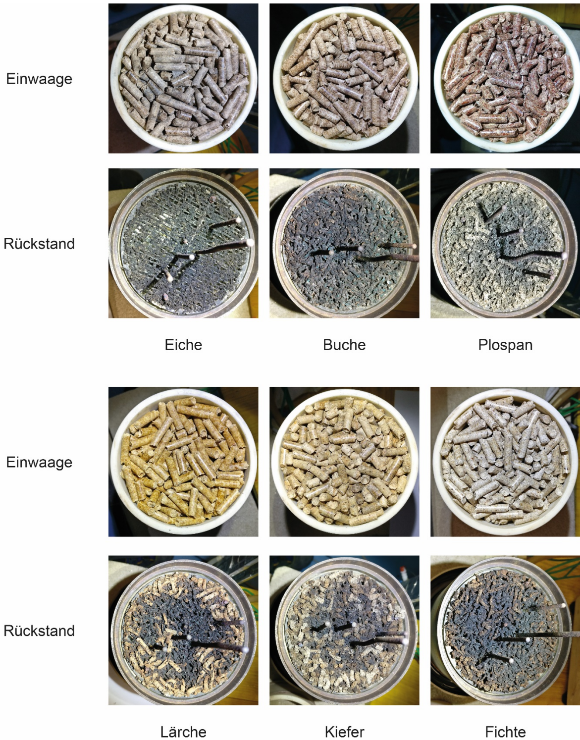
Abbildung 235: Laborreaktortestläufe mit Pelletsortimenten aus unterschiedlichen Ausgangsmaterialien – Bilder der Brennstoffe und der Rückstände (Aschen)
