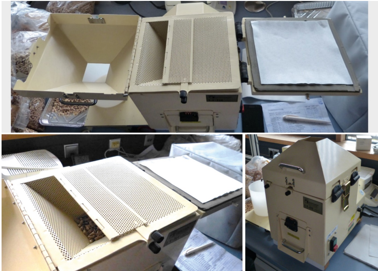
Abbildung 16: Versuchsaufbau System Ligno-Tester, Gerät aufgeklappt Ausgangszustand (oben), Prüfkammer beladen mit Pellets (unten links), Gerät verschlossen während der Prüfung (unten rechts)
