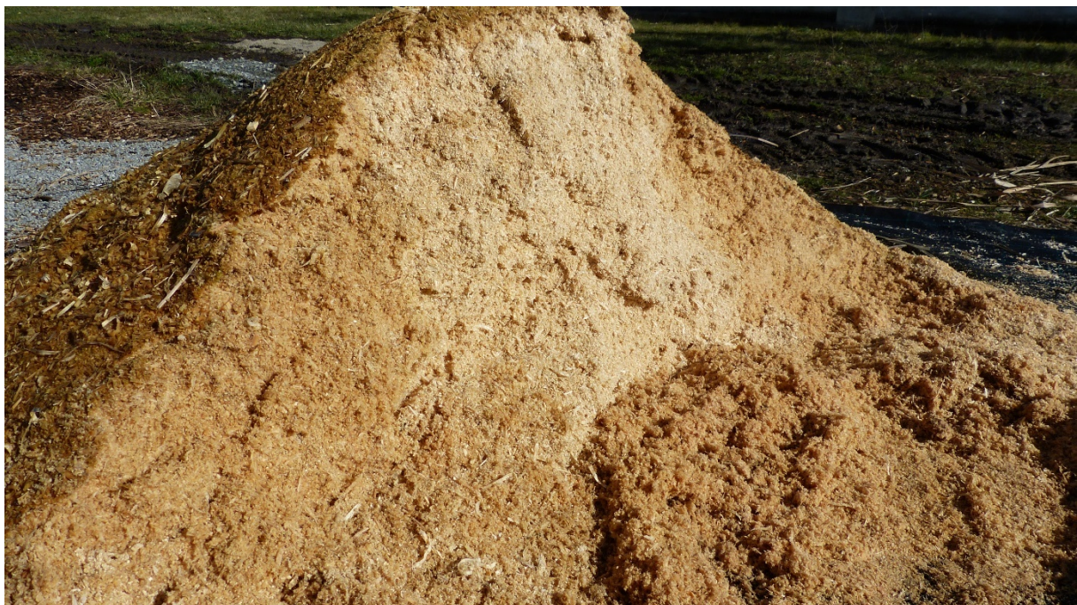
Abbildung 148: Rohmaterial, Sägespan (feucht), sieben Monate im Freien als Miete gelagert
