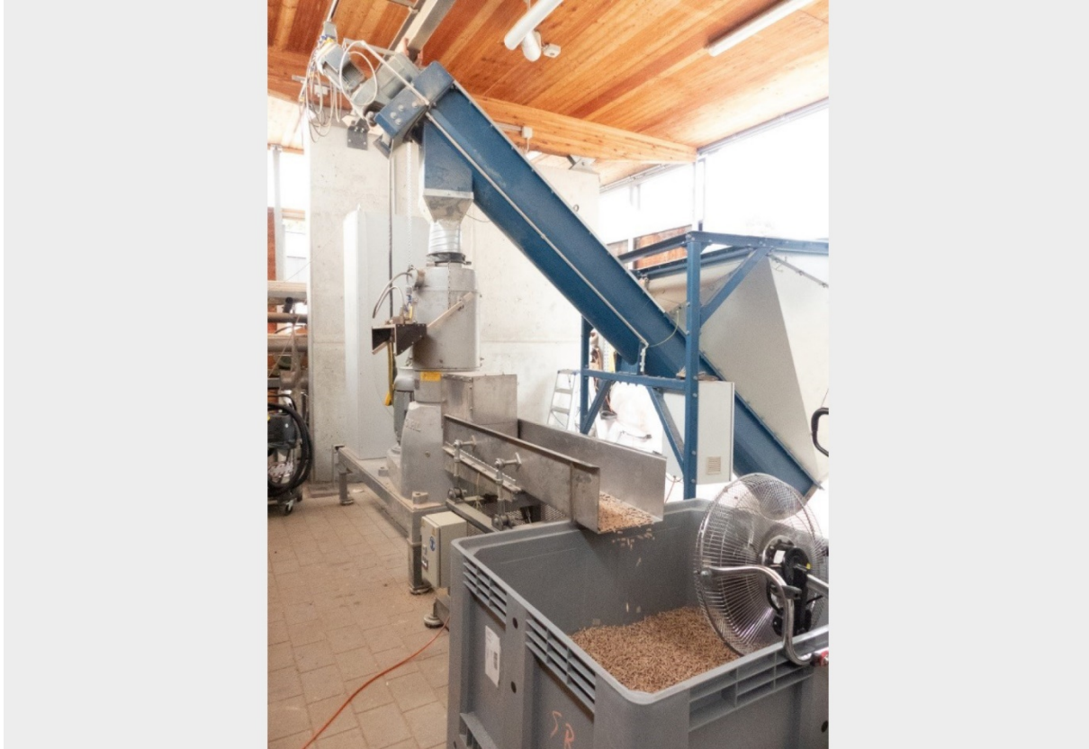
Abbildung 2: Aufbau der Pelletieranlage (Amandus Kahl GmbH & Co. KG, Typ 33-390) am TFZ mit Materialzufuhr und Vibro-Rinne
