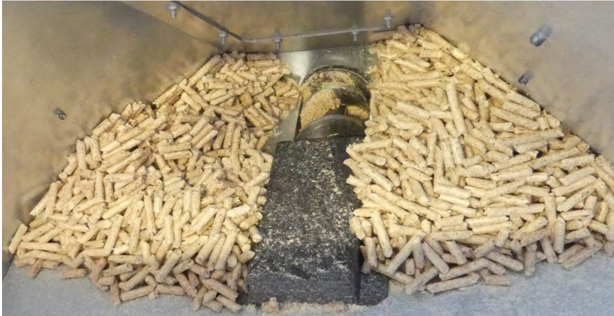
Abbildung 25: Blick in den Pelletbehälter nach Durchlauf von ca. \frac{2}{3} der Probenmenge
