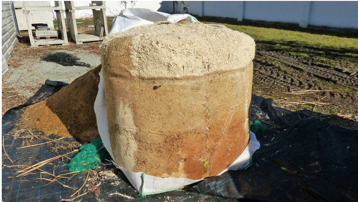
Abbildung 149: Rohmaterial, Sägespan (feucht), sieben Monate im Freien im Bigbag gelagert
