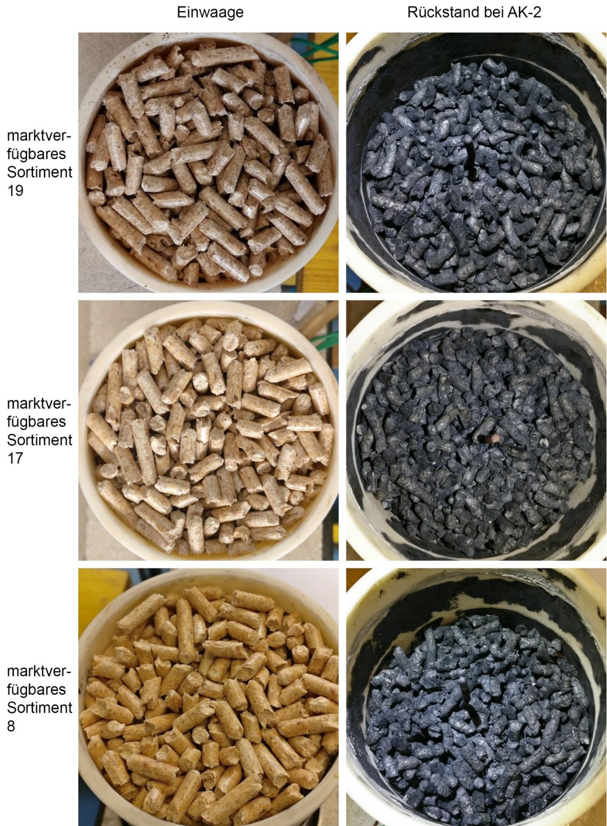
Abbildung 240: Laborreaktorstestläufe mit Reaktionsabbruch – Fotos des Einsatzmaterials sowie der Rückstände bei AK-2 – Testläufe mit marktverfügbaren Sortimenten
