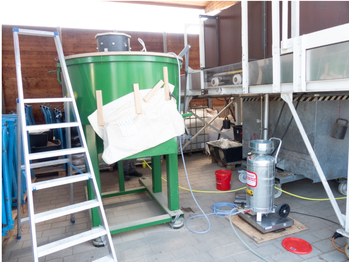
Abbildung 4: Exaktmischer (Stockmann Landtechnik GmbH, Typ 500 ESK) mit Wasserdosierung zur Befeuchtung des gemahlene Rohmaterials mit einer Weißel-Spritze, Waage und im Deckel des Mischers verbauten Düsen
