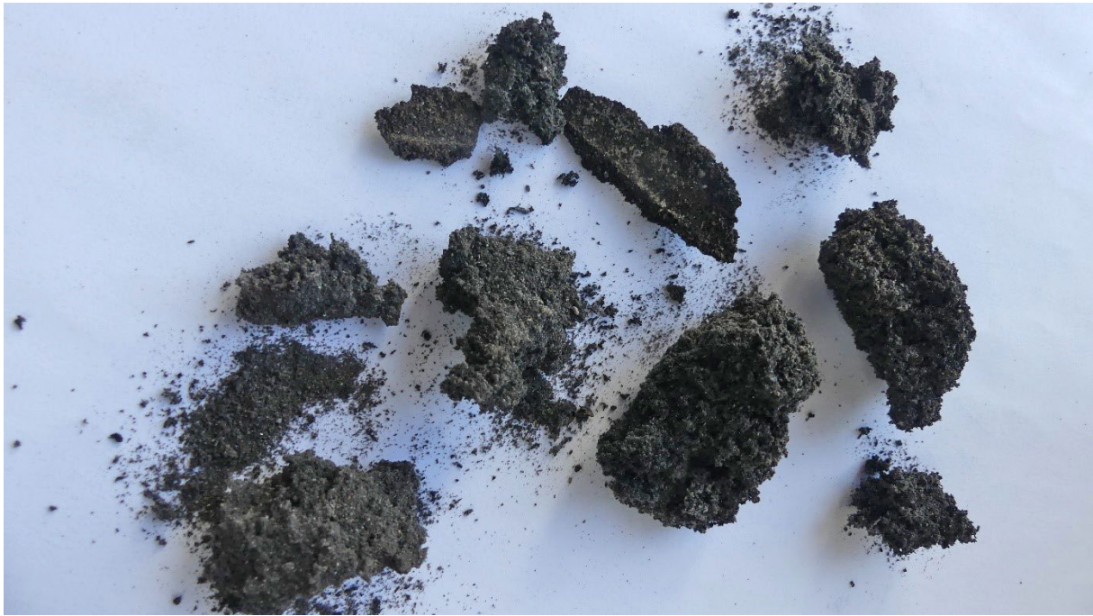
Abbildung 198: Versinterte Rostasche nach 26-h-Versuch mit Sortiment 24 der marktverfügbaren Holzpellets in Pelletkessel 1
