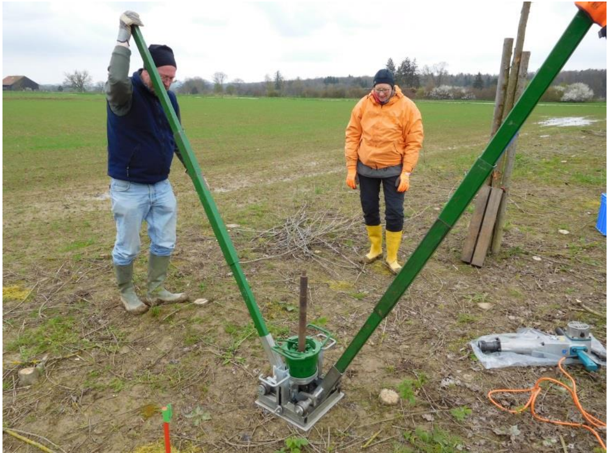
Abbildung 16: Gewinnung der Bodenprobe mit einer RAM-Kernsonde und einem Doppelparmstangenausziehgerät
