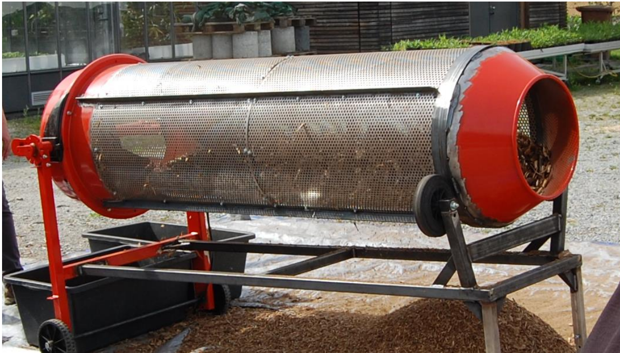
Abbildung 18: TFZ-Trommelsieb mit Lochdurchmesser 8 mm (Rundloch)
