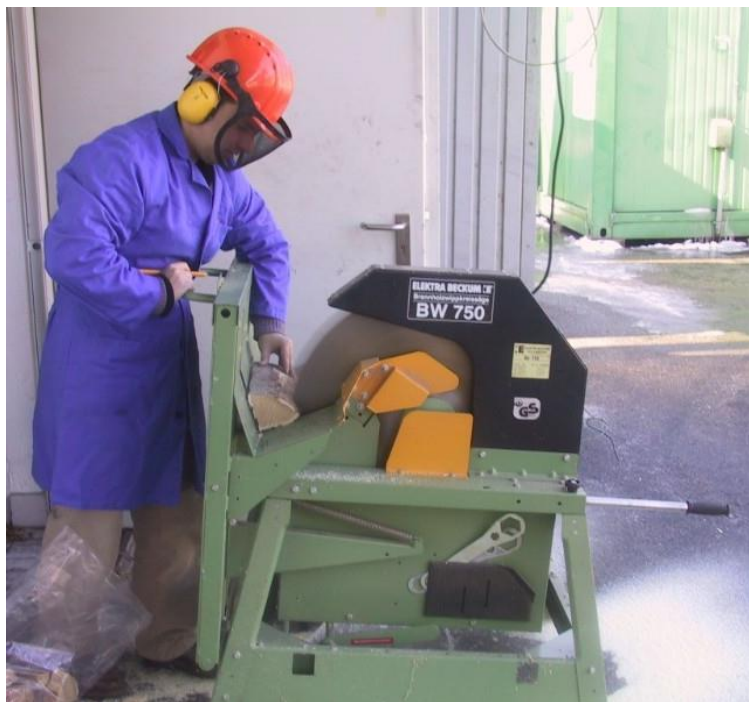
Abbildung 24: Probenahme mit Kreissäge für Wassergehaltsbestimmung
