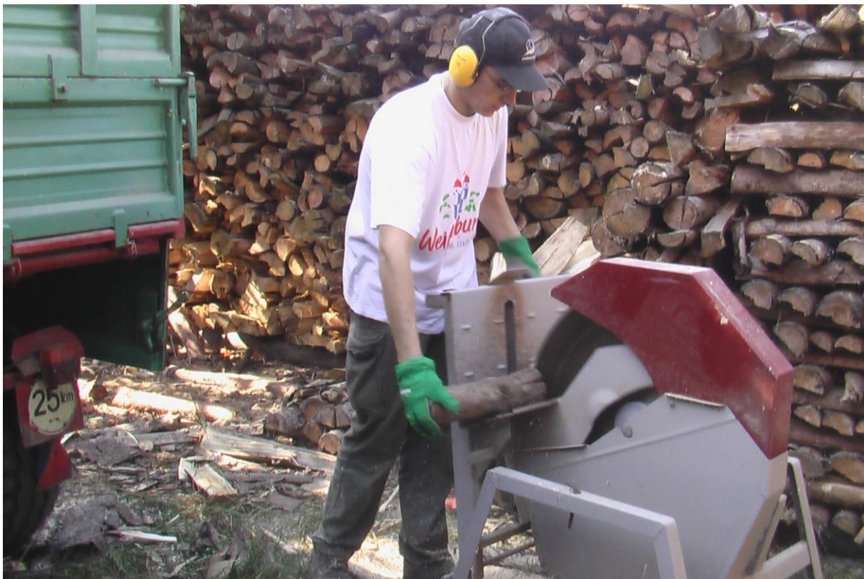
Abbildung 75: Arbeitsplatzbeispiel für Zeitstudie zum Trennschnitt mit der Kreissäge (KR). Hier: WK 771, Fa. BGU
