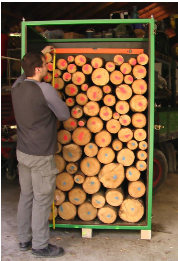
Abbildung 16: Der Messrahmen für die Bestimmung der Scheitholz Raummaße
