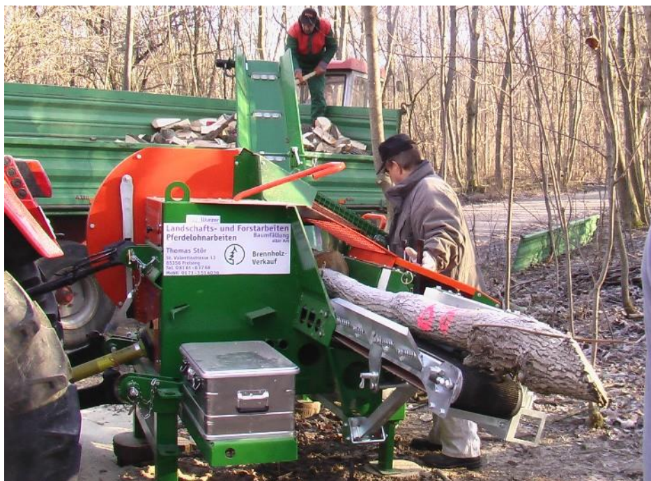
Abbildung 67: Arbeitsplatzbeispiel für Zeitstudie zum Spalten mit der kleinen kombinierten Säge-Spaltmaschine (KK). Hier: Spaltfix 300, Fa. Posch)
