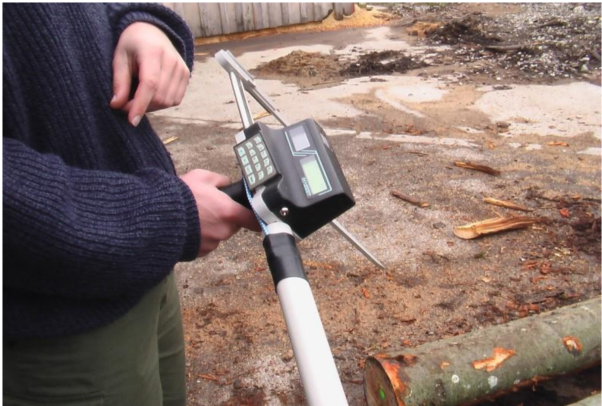
Abbildung 9: Elektronische Kluppe für die Durchmesserbestimmung
