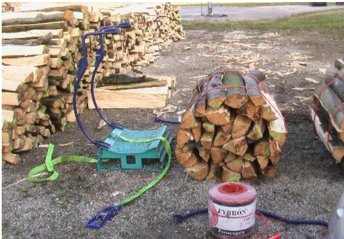
Abbildung 77: Arbeitsplatzbeispiel für das Stapeln und Bündeln mit einer Bündelhilfe, hier für 0,5 Rm-Bündel
