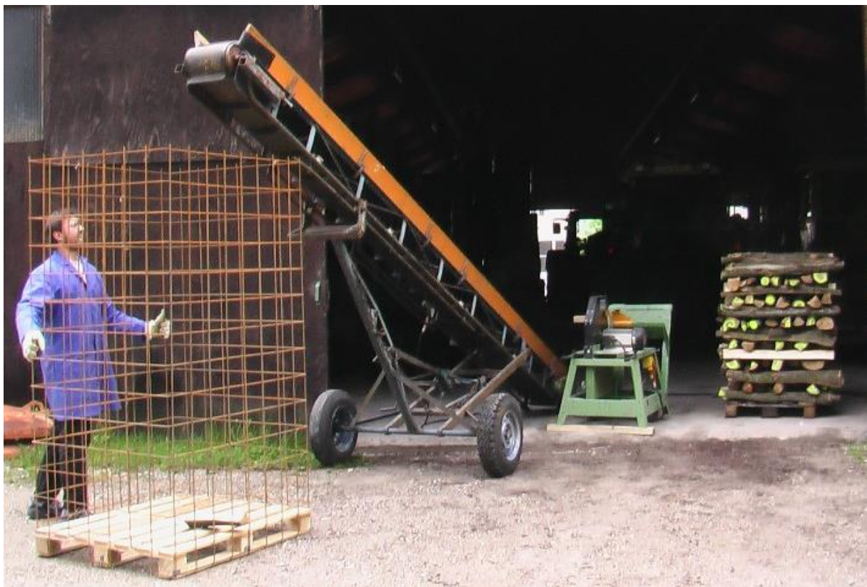
Abbildung 19: Befüllen der Gitterbox für die Schüttvolumenbestimmung
