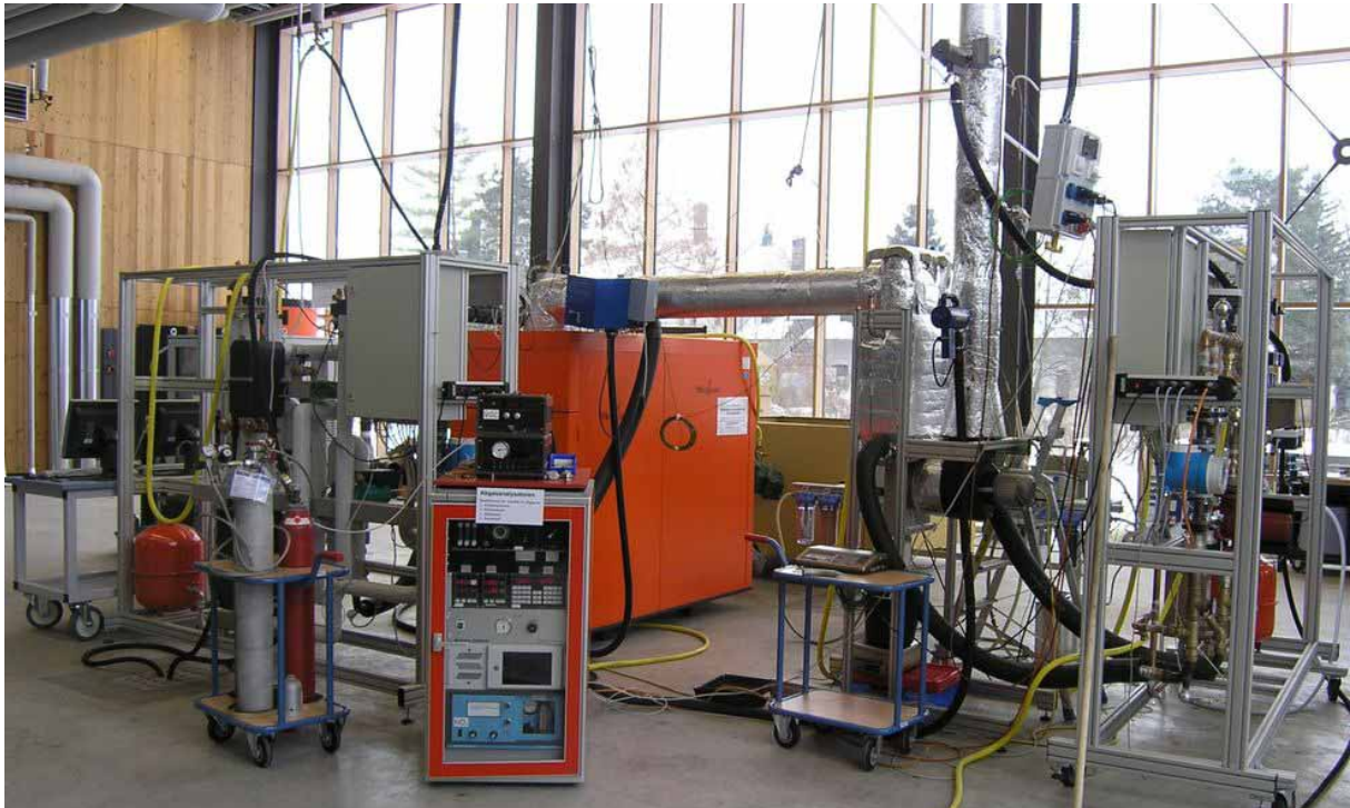
Abbildung 11: Versuchsaufbau im Prüfstand des TFZ mit der Anlage 1 (Heizomat) und dem verwendeten Sekundärwärmetauscher
