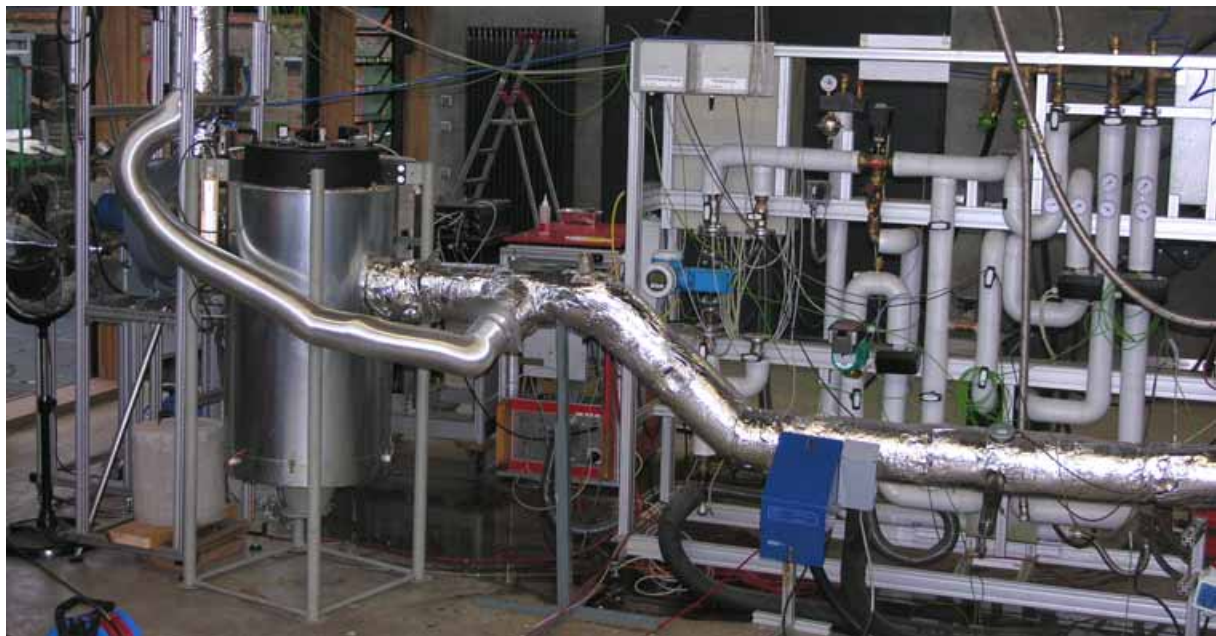
Abbildung 9: Aufbau des Filters im Prüfstand
