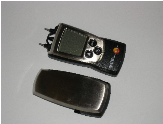
Abbildung 42: Leitfähigkeitsmessgerät Fabrikat testo, Typ 606-1 mit Einstechnadeln
