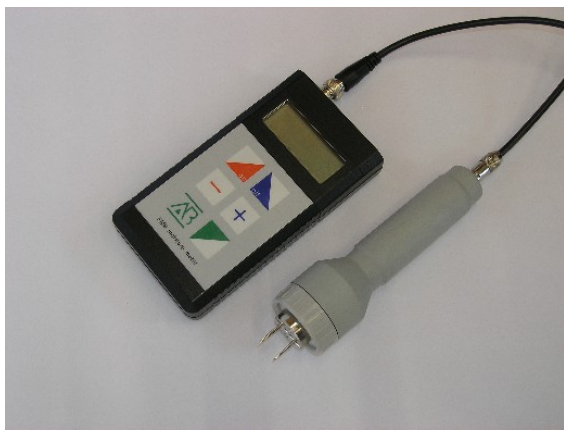
Abbildung 36: Leitfähigkeitsmessgerät Fabrikat PCE, Typ FME mit Fühler NF 4-17
