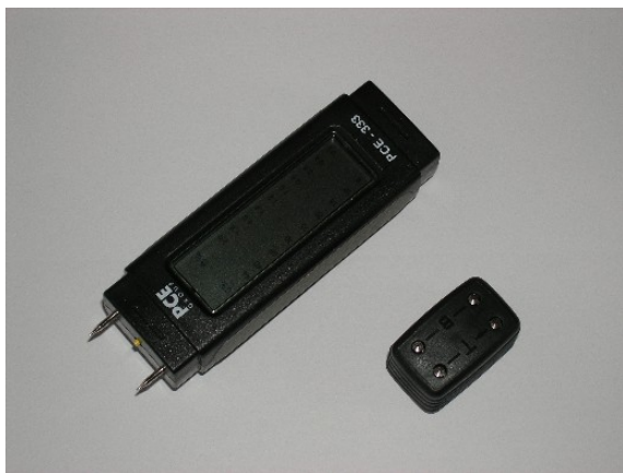
Abbildung 38: Leitfähigkeitsmessgerät Fabrikat PCE, Typ PCE-333 mit Einstechnadeln
