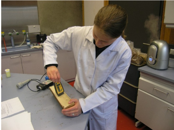
Abbildung 9: Feuchteschnellbestimmung am Beispiel eines Fichten-Holzschaites mit dem Messgerät BES Bollmann, Easy-comfort, Nadelmodus, (links) und Spalten des Holzschaites mit der Axt, (rechts)
