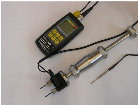
Abbildung 25: Leitfähigkeitsmessgerät Fabrikat Greisinger, Typ GMH 3830 mit Einschlagelektrode GHE 91
