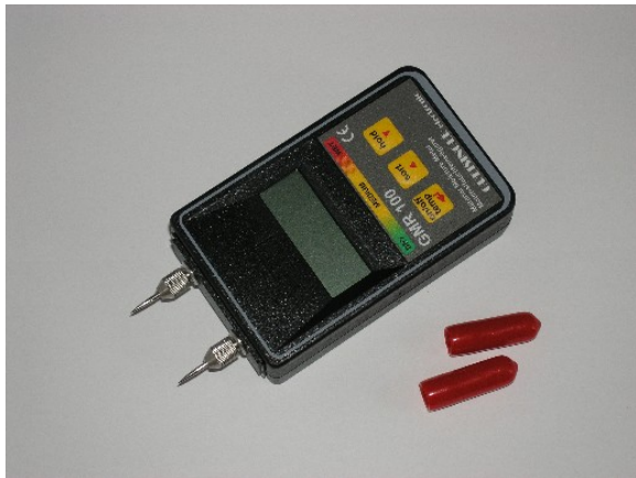
Abbildung 27: Leitfähigkeitsmessgerät Fabrikat Greisinger, Typ GMR 100 mit Einstechnadeln
