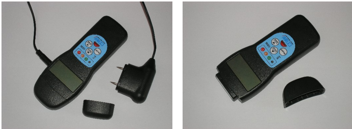
Abbildung 29: Feuchtemessgerät Fabrikat HEDÜ, Typ 2 in 1, mit Einstecknadeln (links) bzw. mit Kondensatorplatte für Messung im Suchermodus (rechts)
