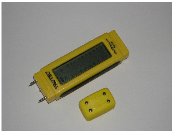
Abbildung 46: Leitfähigkeitsmessgerät Fabrikat TROTEC, Typ T 60 mit Einstechnadeln
