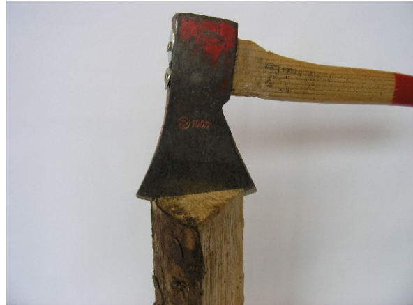
Abbildung 9: Feuchteschnellbestimmung am Beispiel eines Fichten-Holzschaites mit dem Messgerät BES Bollmann, Easy-comfort, Nadelmodus, (links) und Spalten des Holzschaites mit der Axt, (rechts)
