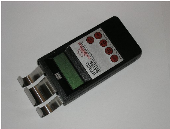
Abbildung 15: Dielektrisches Messgerät Fabrikat Dosser, Typ DM 4 A
