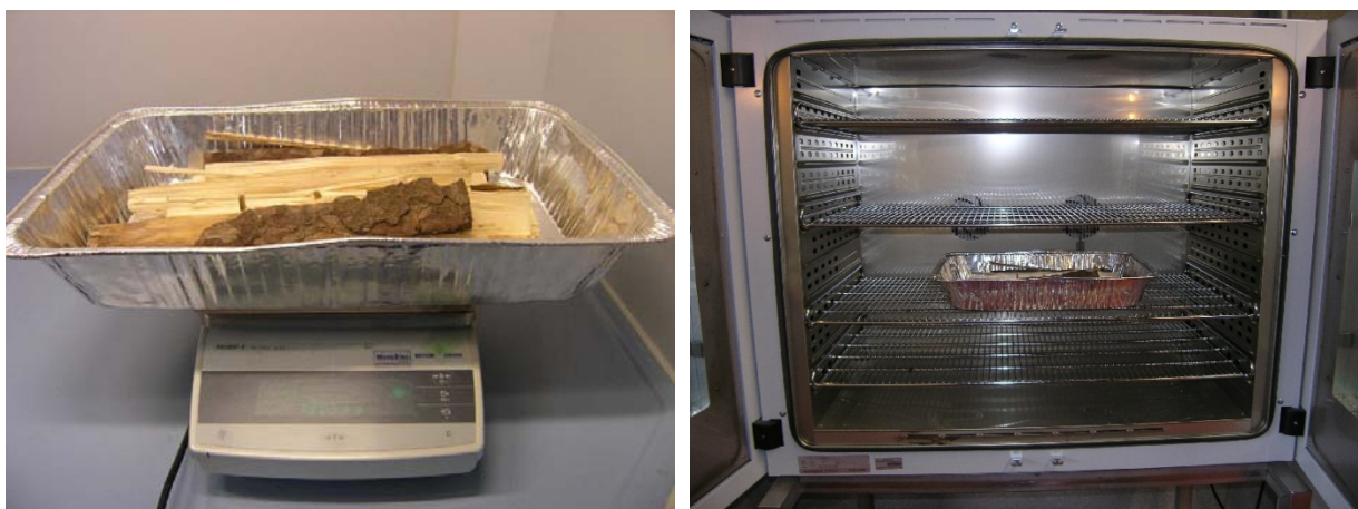
Abbildung 11: Trockenblech mit Probe bei der Wägung im heißen Zustand, mit wärmedämmender Unterlage (links), sowie beladenes Trockenblech im Trockenschrank (rechts)
