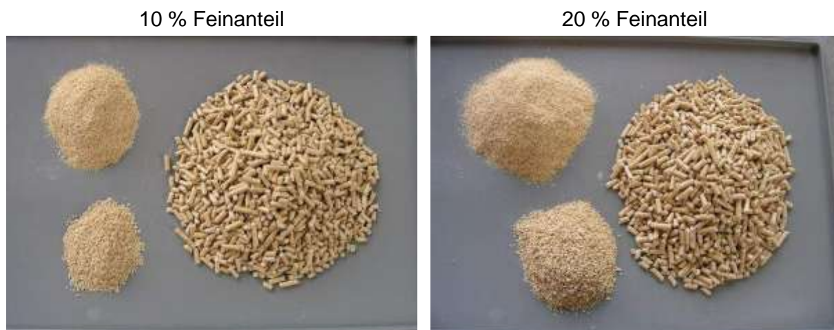
Abbildung 14: Pellets mit definiertem Feingehalt (Fraktion 1, jeweils links oben: <2 mm; Fraktion 2, jeweils links unten: 2 bis 3,15 mm)
