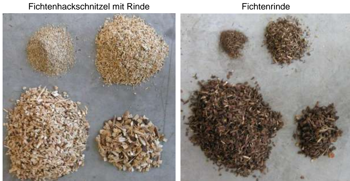
Abbildung 16: Versuchsbrennstoffe für die Bestimmung des Aschegehaltseinflusses, Größenklassen nach Siebanalyse mit 3,15 mm, 8 mm und 45 mm Sieb
