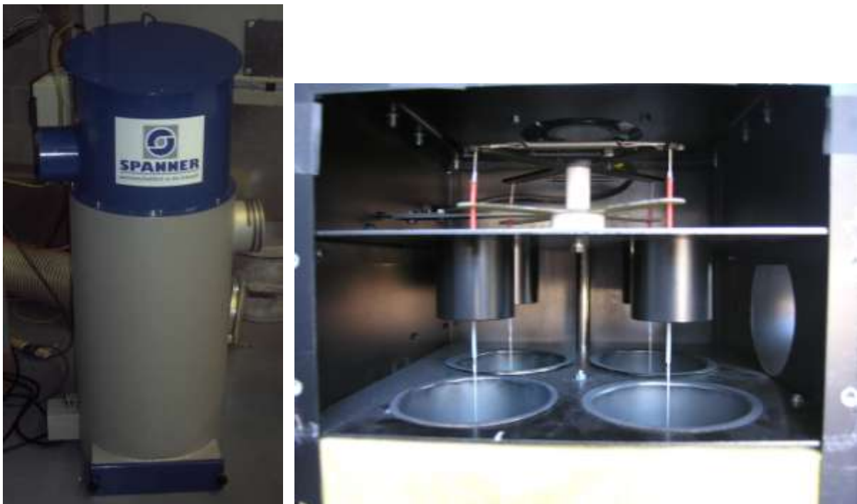
Abbildung 13: Prototyp eines sekundären Staubabscheiders ("Kleinst-Elektrofilter"). Hersteller: Spanner Re 2 GmbH, Neufahrn n. Niederbayern links: Gesamtansicht, rechts: Einblick in Elektrodenhalterung mit Belüftungseinrichtung
