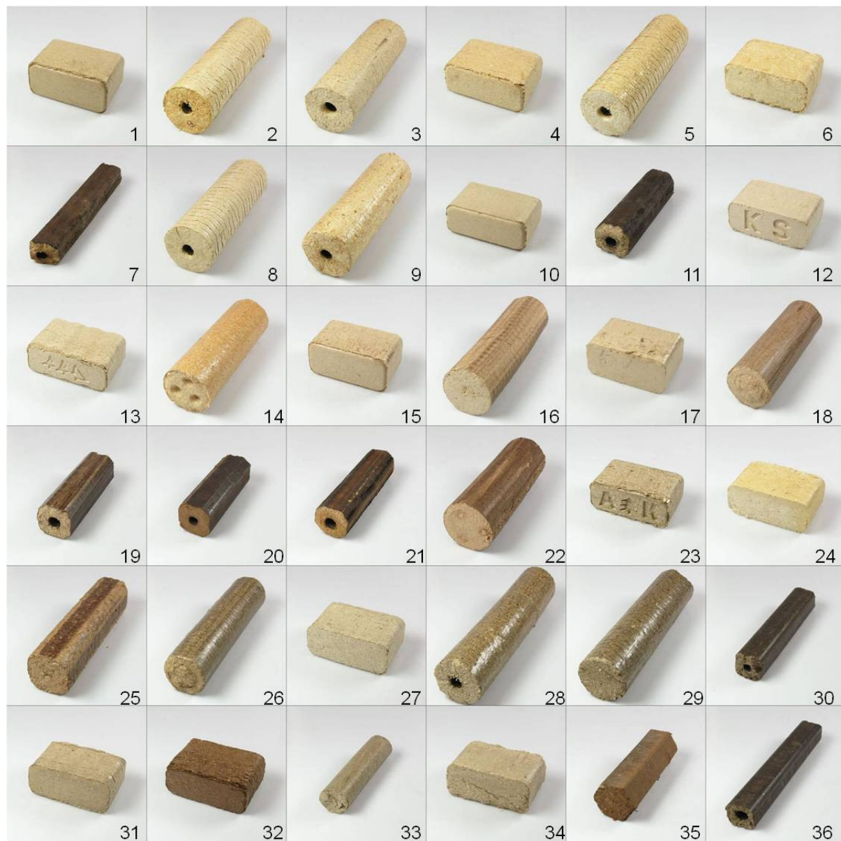
Abbildung 1: Untersuchte Holzbriketts. Alle Bilder wurden aus der gleichen Perspektive aufgenommen, so dass die tatsächlichen Größenverhältnisse korrekt wiedergegeben sind. Nummer 32 und 35 sind reine Rindenbriketts.
