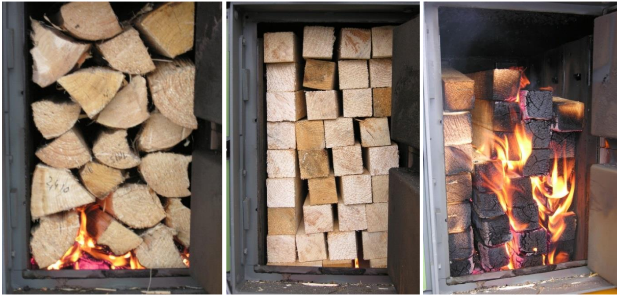
Abbildung 78: Einsatz von Scheit- und Kanthölzern im Scheitholzkessel HDG Navora, links: direkt nach dem Befüllen des Füllschachtes mit Scheitholz. Mitte: Befüllen mit Kantholz, rechts: nach der ersten einstündigen Messung brennt der gesamte Holzvorrat, die Verbrennung ist nicht auf den Glutbettbereich beschränkt
