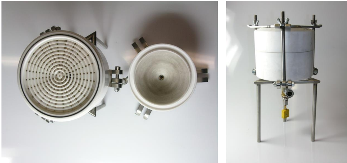
Abbildung 11: Filterhalter fur groe Planfilter mit 150 mm Durchmesser, Eigenentwicklung des TFZ
