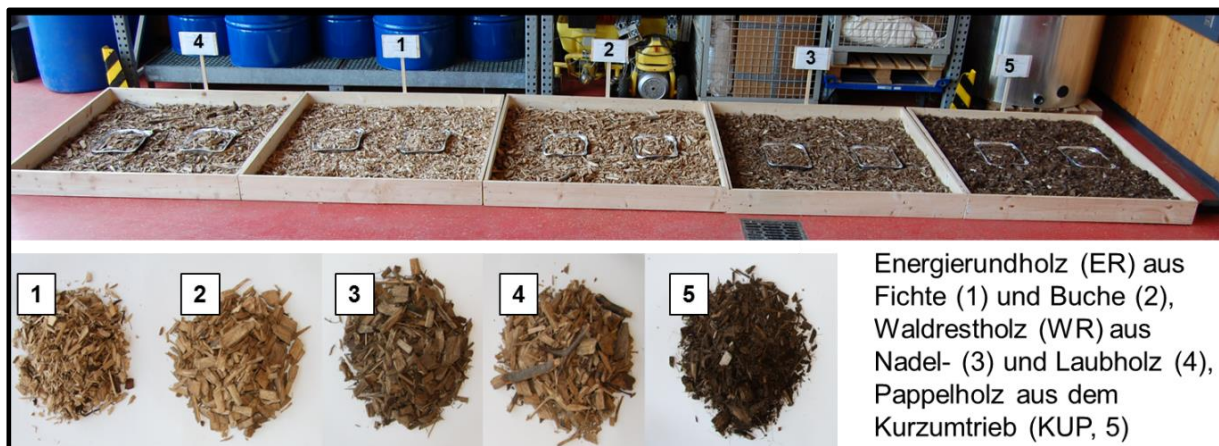
Abbildung 5: Gewählte Hackschnitzelsortimente und Trocknungsboxen zum Erreichen der Wassergehaltsstufen im Technikum des TFZ
