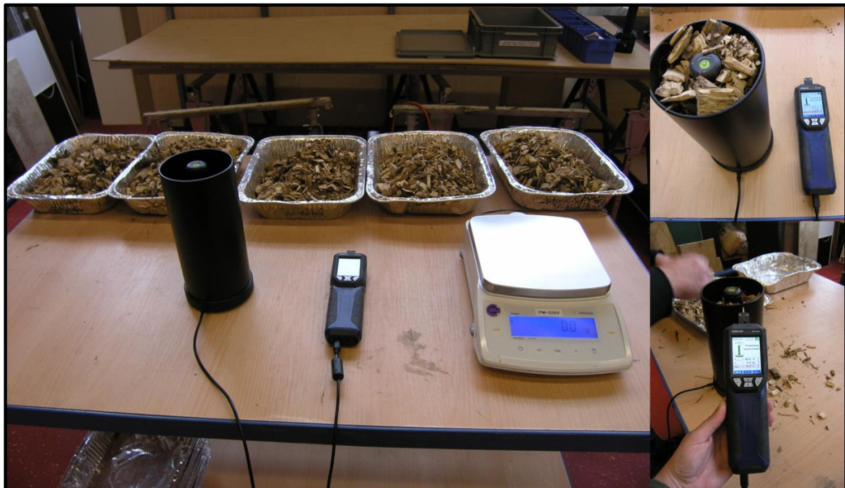
Abbildung 23: Messdurchführung und Messgerät: Wöhler HF550/FW550
