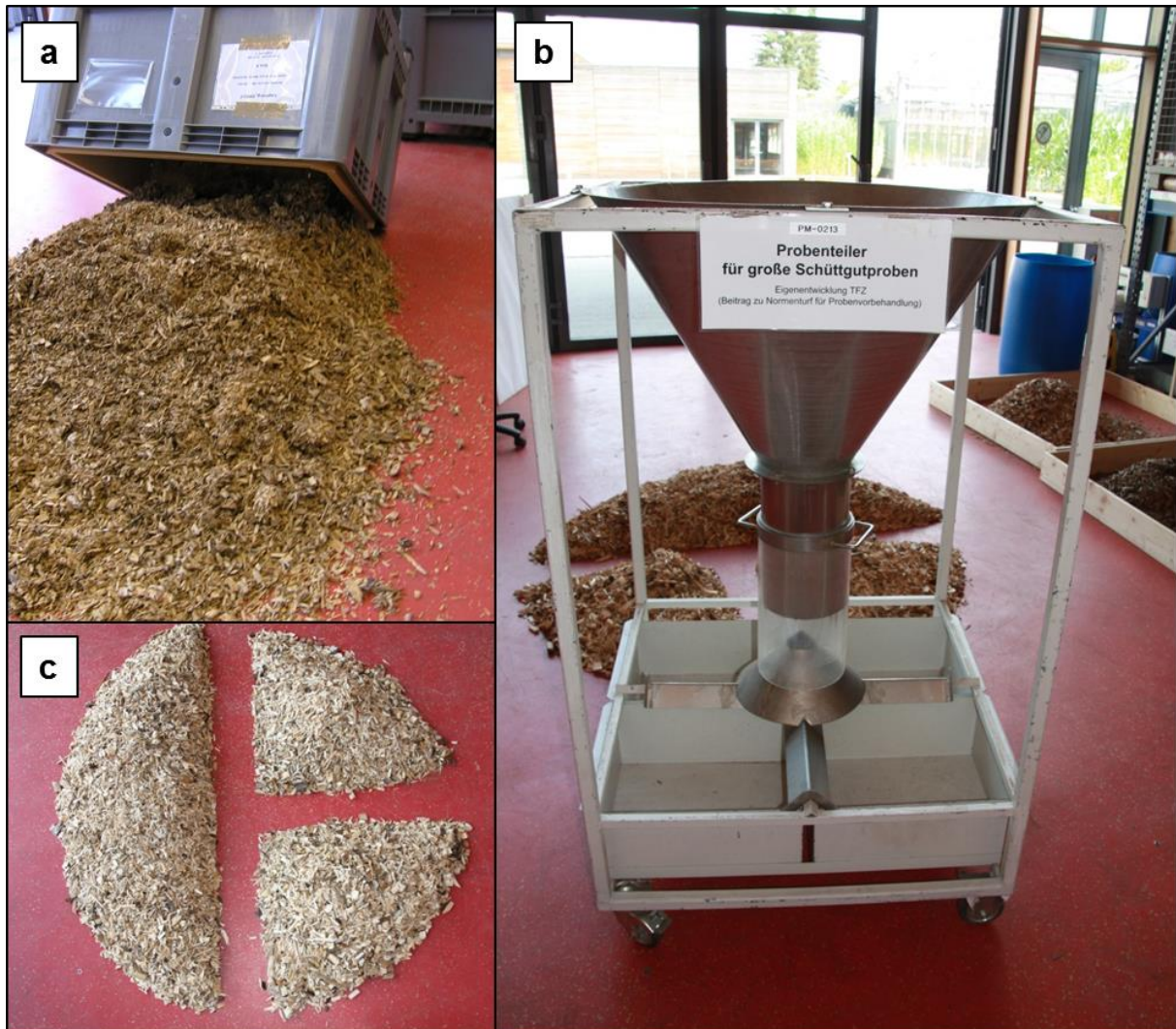
Abbildung 39: Entleeren des Behältermaterials (a) und anschließende Homogenisierung und Probenteilung (b, c) der Hackschnitzel nach der Lagerung
