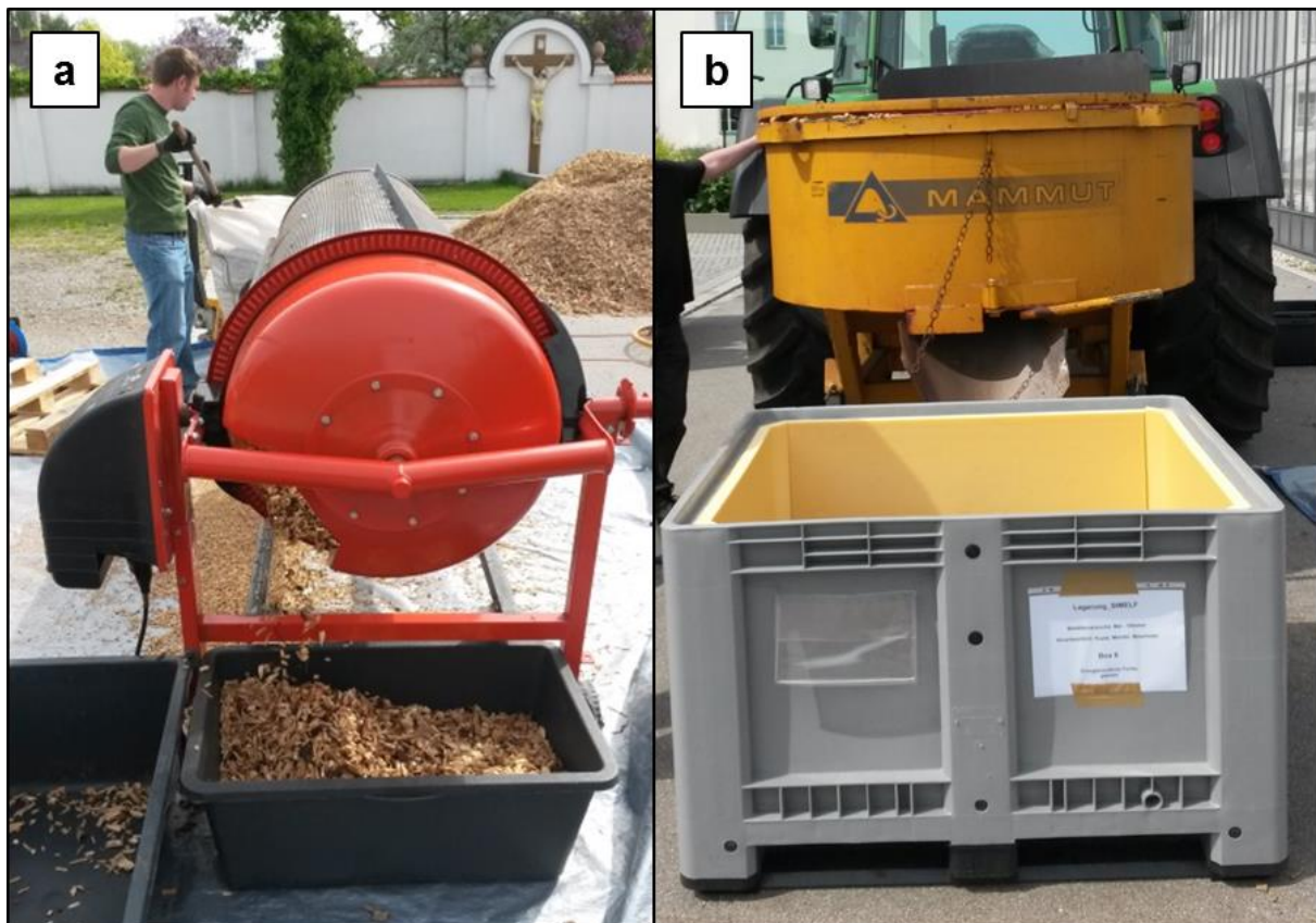
Abbildung 37: Siebung (a) und Homogenisierung (b) der Hackschnitzelsortimente
