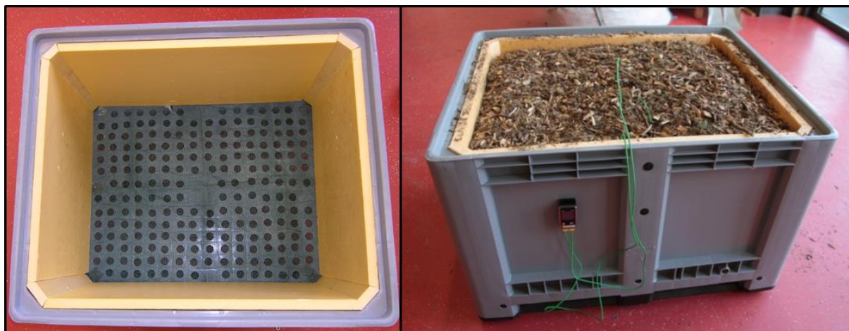
Abbildung 7: Leerer (links) und mit Hackenschnitzeln befüllter Behälter (rechts) mit einem Füllvolumen von 610 l, einer Isolierung und eingebauten Temperatursensoren
