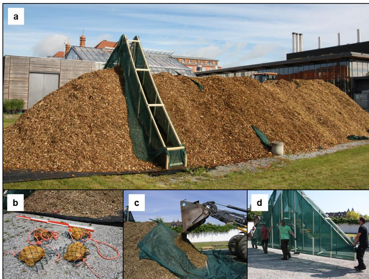
Abbildung 4: Vorversuchsmiete am Betriebshof des TFZ (a) mit den drei Beprobungsvarianten: Bilanzbeutel (b), Beprobung einer Mietenschicht im Schüttwinkel (Schicht, c), Beprobung eines horizontalen Segments (Gestell-Schicht, d)
