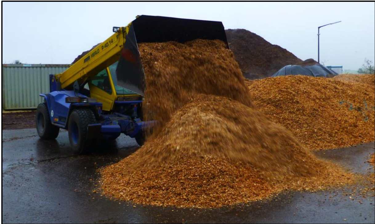
Abbildung 10: Homogenisierung der Hackschnitzel mit dem Radlader zur Gewinnung von einheitlichem Probenmaterial zur Befüllung der Bilanzbeutel
