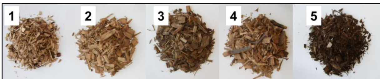
Abbildung 36: Untersuchte Hackschnitzelsortimente: Energierundholz aus Fichte (1) und Buche (2), Waldrestholz aus Nadel- (3) und Laubholz (4) und Pappelholz aus dem Kurzumtrieb (5)
