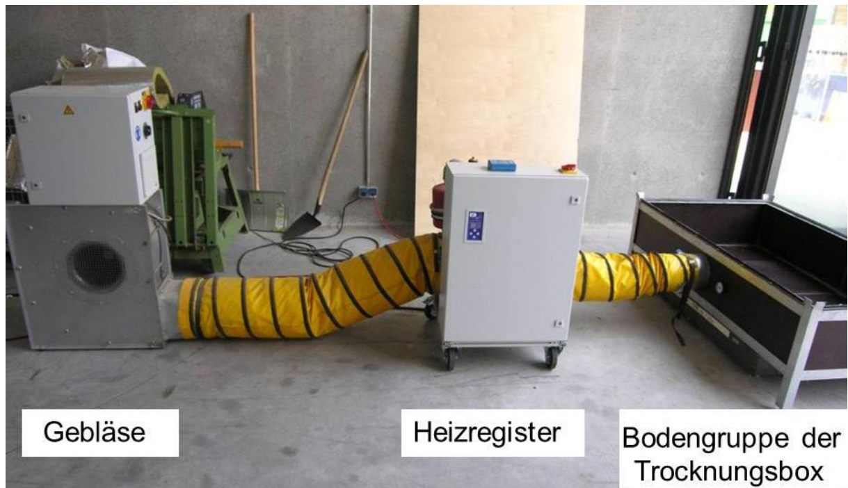
Abbildung 17: TFZ-Trocknungseinrichtung für große Schüttgutproben
