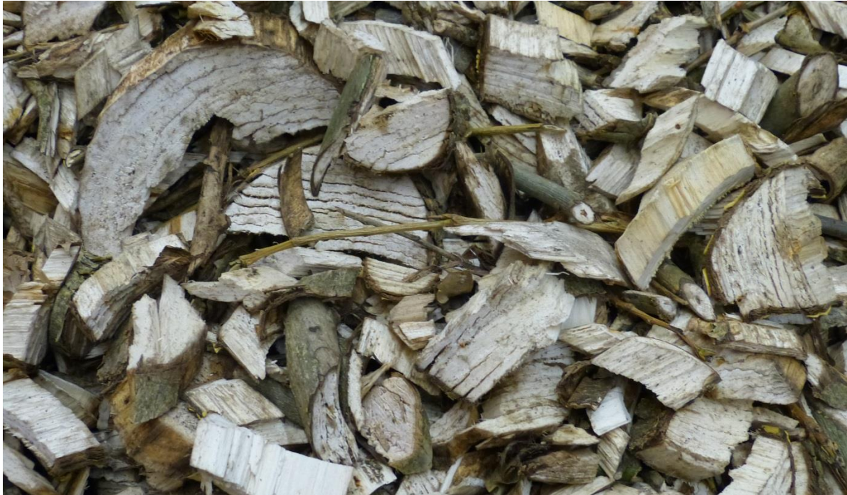
Abbildung 30: Effits-Hackschnitzel des Alvattec-Schneckenhackers aus KUP (Pappel)
