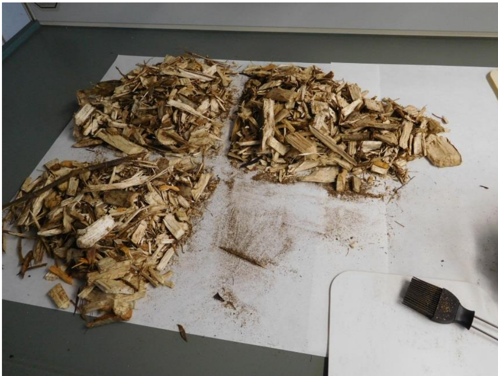
Abbildung 20: Probenteilung in Anlehnung an DIN EN ISO 14780 (Entwurf)
