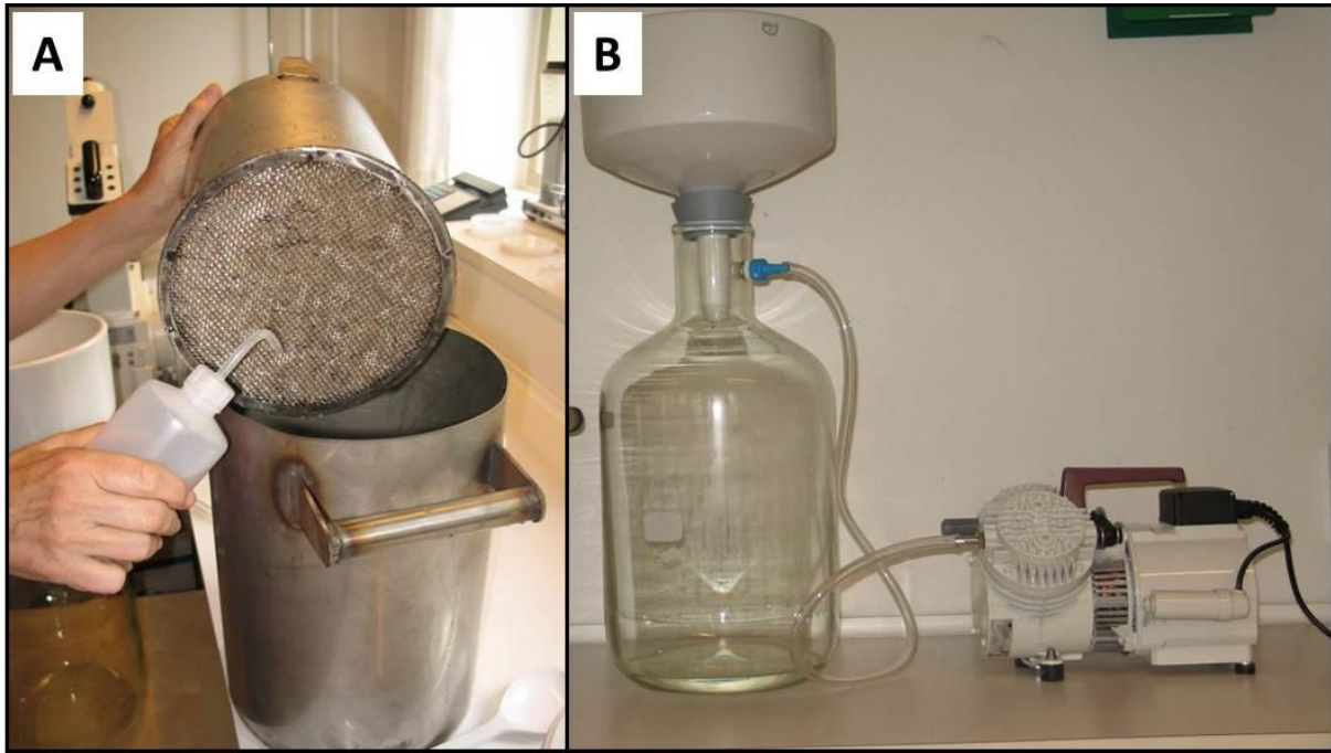
Abbildung 22: Probenwaschen nach BioNorm 2 (A) und Abfiltern des Rückstands (B) [6]
