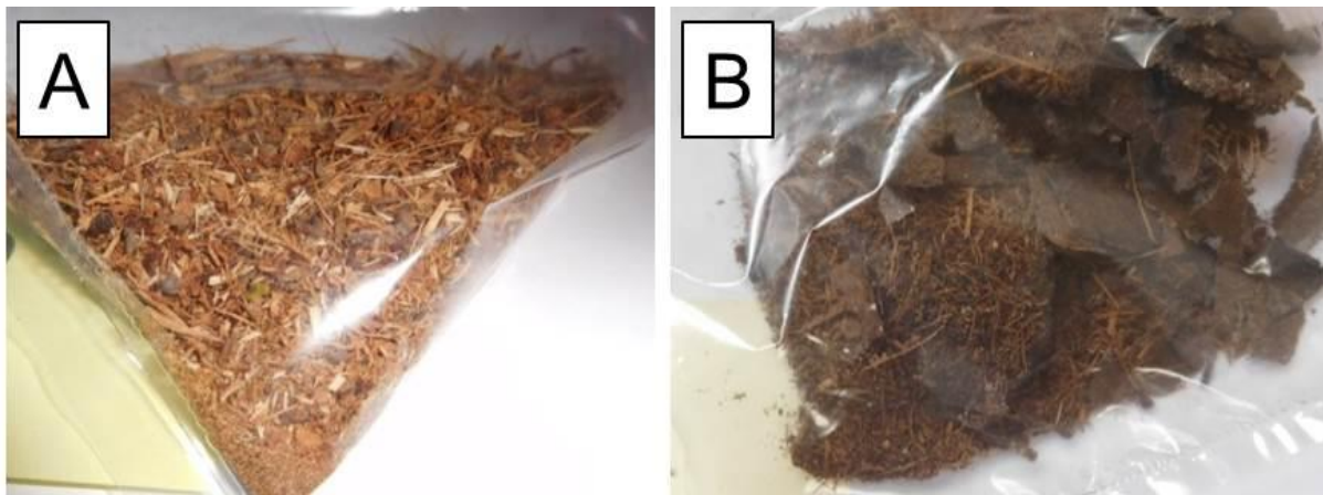
Abbildung 74: Zusammensetzung der Filterkuchen (extreme Fallbeispiele). A: Filterkuchen vorwiegend aus holzigem Material. B: Filterkuchen z. T. aus holzigem Material, aber auch mit hohem Zuckeranteil, der aus der Flüssigkeit zum Schweretrennen stammt
