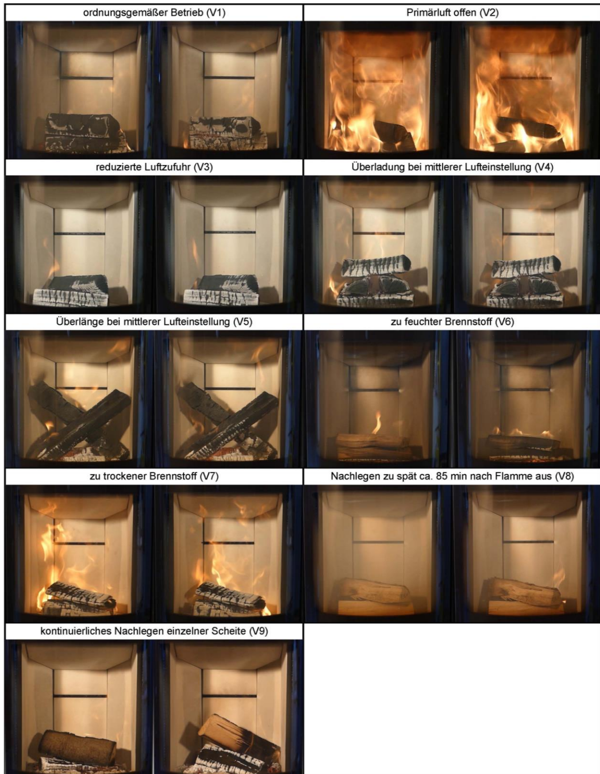
Abbildung 17: Vergleich der Flammenbilder der untersuchten Nachlegevarianten etwa zur Mitte des jeweiligen Abbrands; Zeitversatz linkes und rechtes Bild: ca. 1 min (bei V9 ca. 15 min)
