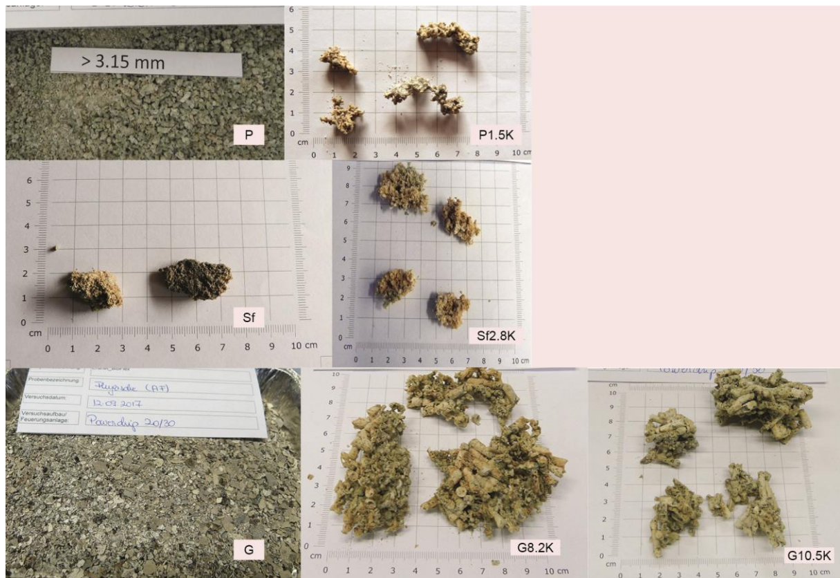
Abbildung 38: GröÙte aus dem Kessel entnommene Schlackebrocken der Pappel- (obere Zeile), Sonnenblumenspelzen- (mittlere Zeile) und Grasbrennstoffe (untere Zeile) im Vergleich
