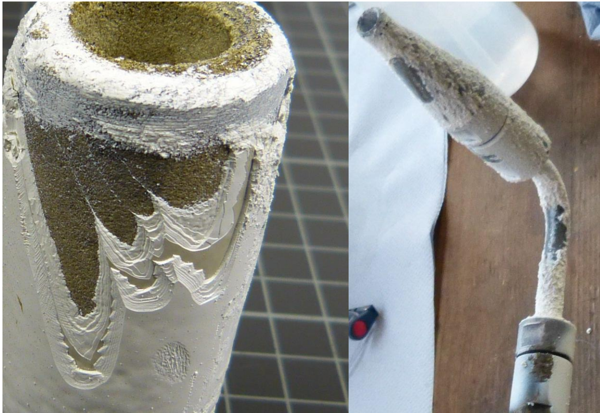
Abbildung 35: Ablagerungen an dem Filter der Abgasprobenahmesonde (links) und der Staubprobenahmesonde (rechts) nach einem Versuchstag (8 h Volllastbetrieb + 2 h Aufheizdauer) mit reinen Graspellets
