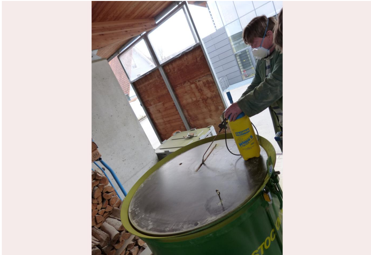
Abbildung 6: Befeuchtung des gemahlene Rohmaterials mit einem Drucksprühgerät (GLORIA Haus- und Gartengeräte GmbH, prima 5 Typ 42 E)
