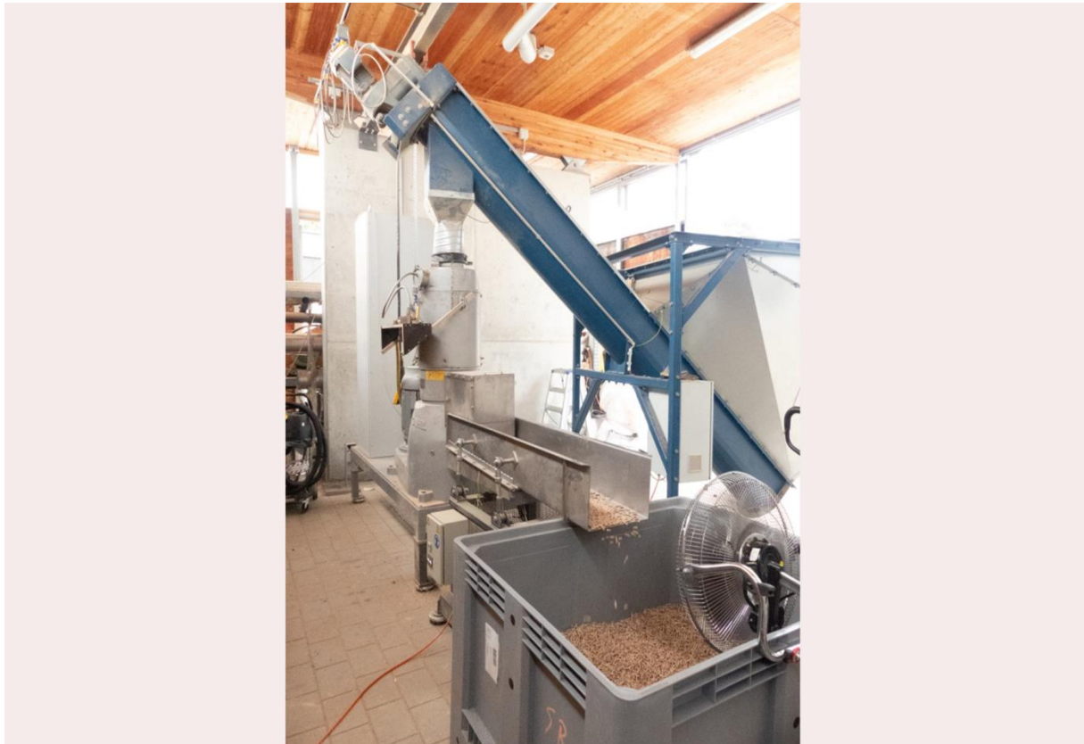
Abbildung 3: Aufbau der Pelletieranlage (Amandus Kahl GmbH & Co. KG, Typ 33-390) am TFZ mit Materialzufuhr und Vibro-Rinne
