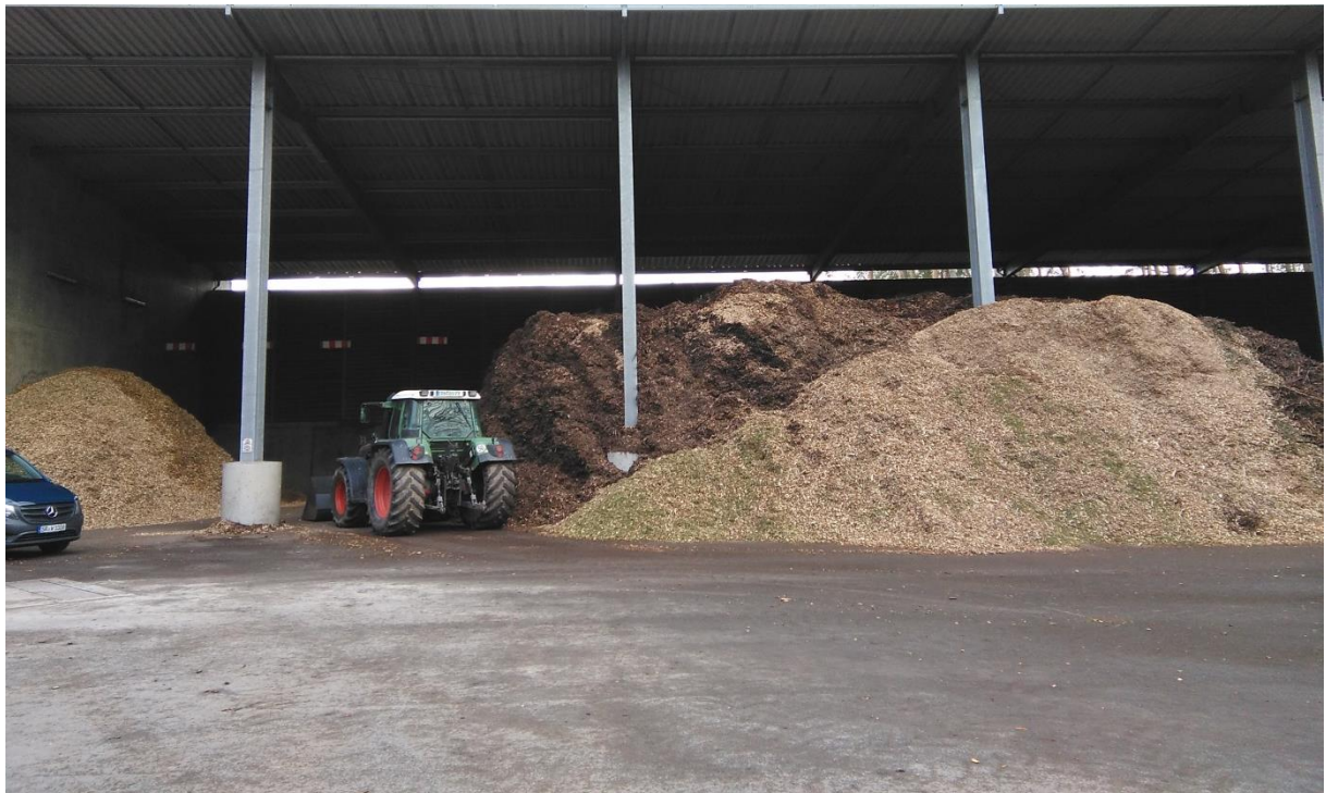
Abbildung 7: Überdachte Brennstofflagerung bei der Feldanlage 2 mit hellen und dunklen Hackschnitzeln unterschiedlicher Qualität
