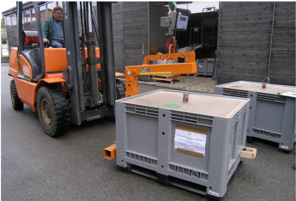
Abbildung 22: Regelmäßige Wiegung der Behälter mittels einer Kranwaage
