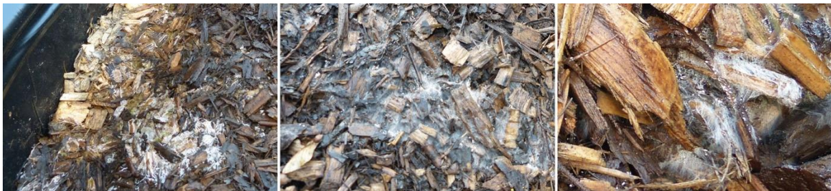
Abbildung 56: Optische Beispiele für das Wachstum von Pilzen beim Abbau der Lager-silos in Versuchsreihe B
