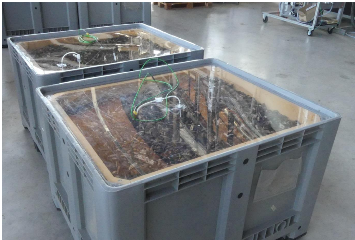
Abbildung 40: Mit Plexiglas und Silikon gasdicht verschlossene Behälter für die anaerobe Lagerung von Holzhackschnitzeln. Jeder Behälter wurde mit einem Temperatursensor (grünes Kabel) und einem verschließbaren Anschluss für einen Gassammelbeutel ausgestattet (Versuchsreihe B)
