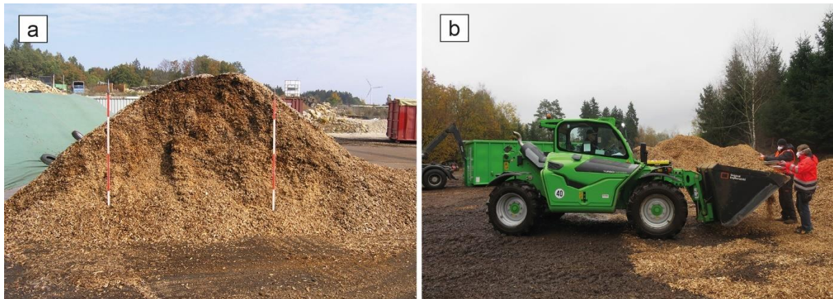
Abbildung 62: Probenahme am Lagerplatz (a = am Mietenquerschnitt, b = beim Umladen in den Transportcontainer)
