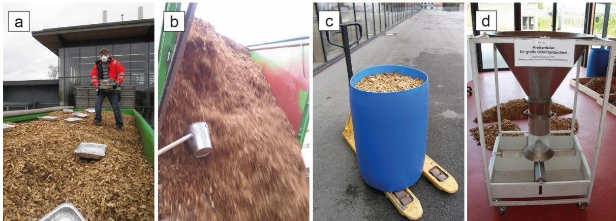
Abbildung 63: Probenahme bei Lieferung (a = an der Oberfläche des Containers, b = beim Abkippen in den Bunker – Varianten a, c = homogenisierte Probe – Varianten b, d = Homogenisierung mittels Probenteiler)
