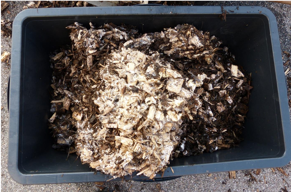
Abbildung 57: Deutliche Verklumpung der Partikel durch das Wachstum von Pilzmyzelien beim Abbau der Silos in Versuchsreihe B
