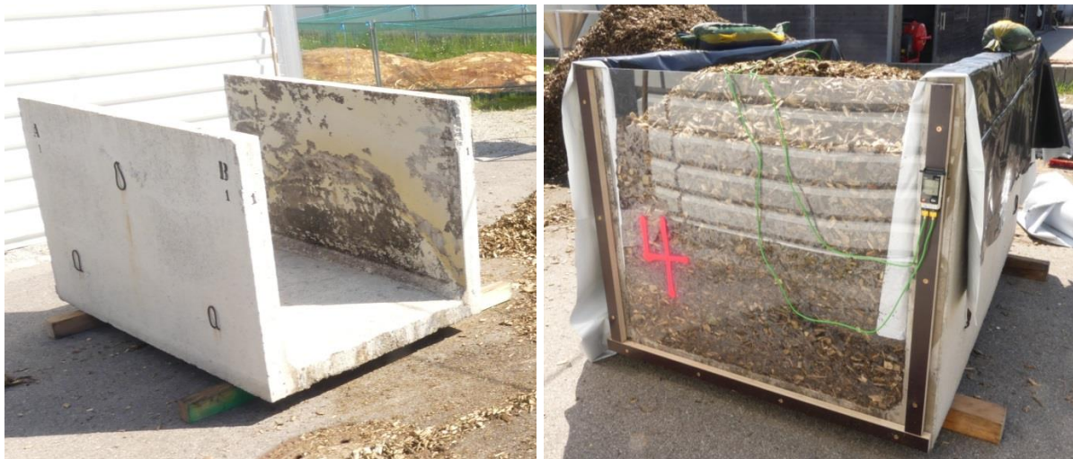
Abbildung 41: Leeres Betonsilo (U-Profil) vor der Lagerung (links); mit Holzhackschnitzeln gefülltes Betonsilo inkl. Plexiglaswand, Temperatursensoren und Silofolie (rechts)
