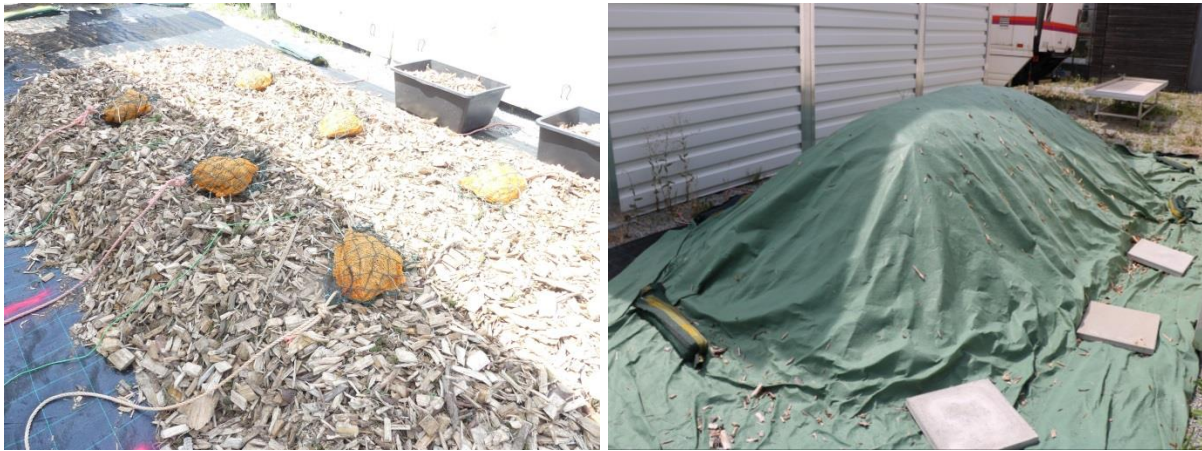
Abbildung 44: Einbau der untersten Bilanzbeutelerschicht in die Lagermiete (links) und mit Vlies abgedeckte Miete (rechts)
