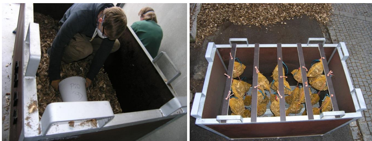
Abbildung 72: Wassergehaltsprobenahme in Versuchsreihe 1 zur technischen Trocknung. Links: manuelle Probenahme, rechts: Verteilung der Bilanzbeutel vor der Auffüllung der Box mit losen Holzhackschnitzeln
