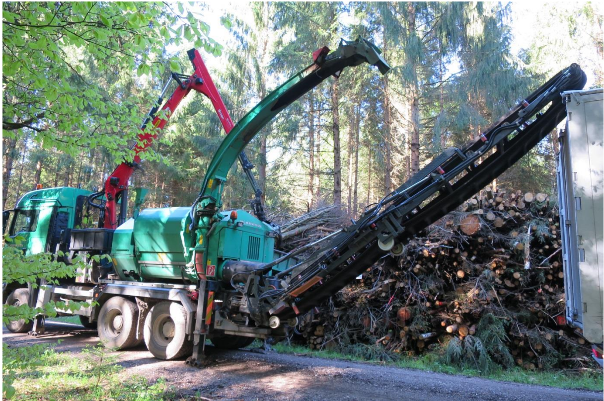
Abbildung 20: Hacken des Brennstoffs mit dem Trommelhacker Jenz A 582R und Förderbandaustrag
