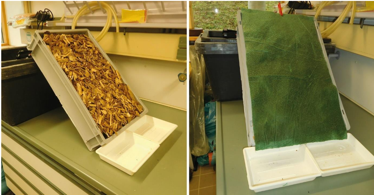
Abbildung 91: Labortest zum Wasseraufnahme- und -abgabevermögen eines 62 cm × 36 cm großen Vliesausschnitts im 45°-Winkel auf Energierundholzhackschnitzeln (links ohne Vlies, rechts mit Vlies)
