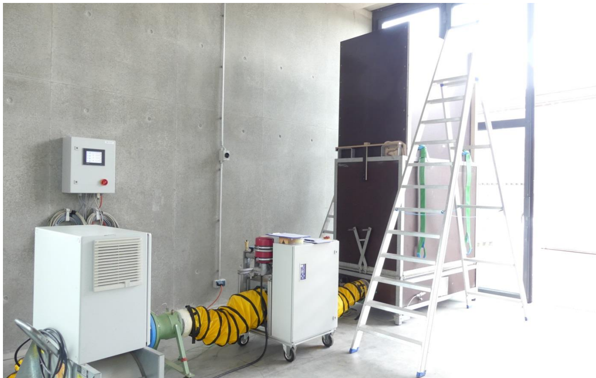
Abbildung 75: Trocknungseinrichtung mit Erweiterung der Trocknungsbox auf eine Höhe von 2,3 m
