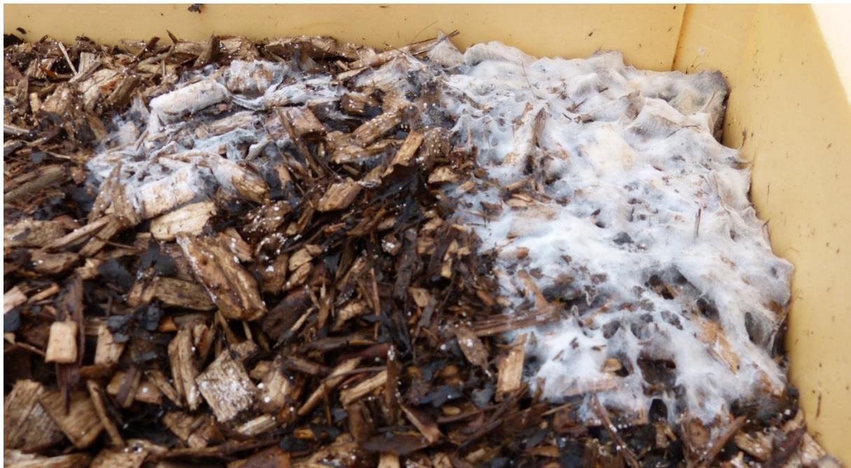
Abbildung 49: Deutliche Myzelienbildung auf der Oberfläche der KUP-Hackschnitzel in einem anaerob gelagerten Behälter beim Abbau in Versuchsreihe B
