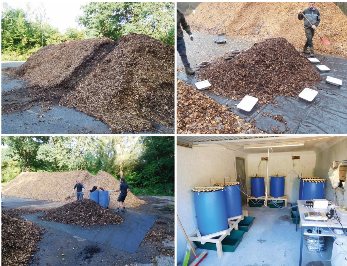
Abbildung 125: Oben links: Waldrestholzhackschnitzelmiete nach der zweiten Beprobung: Entnahme einer ca. 1 m breiten und 25 cm mächtigen Holzhackschnitzelschicht quer über den gesamten Mietenkörper. Oben rechts: Beprobung der händisch homogenisierten Waldrestholzhackschnitzel. Unten links: Befüllung der Beregnungsfässer nach der Holzhackschnitzelbeprobung. Unten rechts: Aufbau des Beregnungsversuchs mit Laborschlauchpumpe, Beregnungsgittern, mit Holzhackschnitzeln befüllte HDPE-Fässer mit Lochboden, Holzgestellen und lebensmittelechten Aufgangwannen in einer Garage auf dem Lagerplatz.
