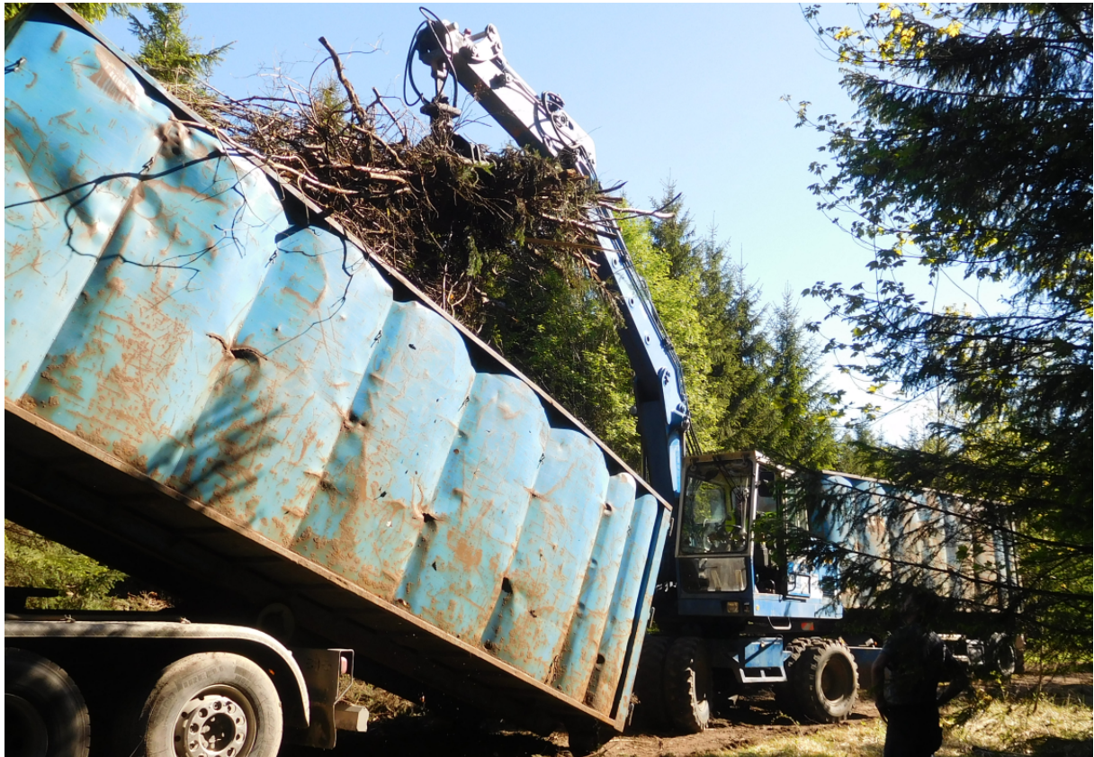
Abbildung 5: Aufladen des Waldrestholzes im Wald mit einem Bagger zangenweise abwechselnd in zwei Hakenliftcontainer mit je 40 m 3 Volumen
