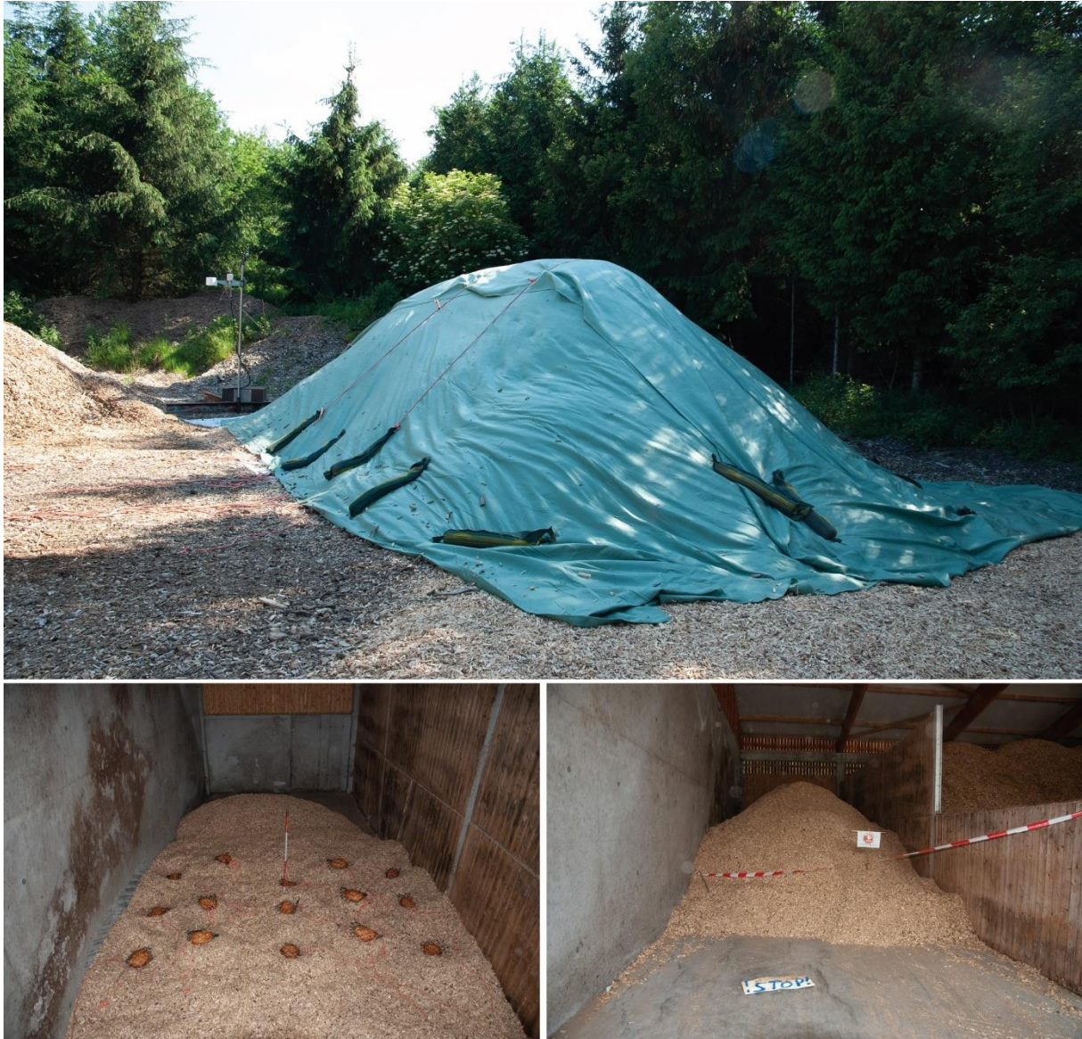
Abbildung 93: Miete aus technisch getrockneten Energierundholzhackschnitzeln mit Vliesabdeckung und Wetterstation im Freien (oben). Aufbau der Vergleichsmiete in der Lagerhalle mit Bilanzbeuteln zur Probenahme (unten links). Fertiggestellte Vergleichsmiete (unten rechts)
