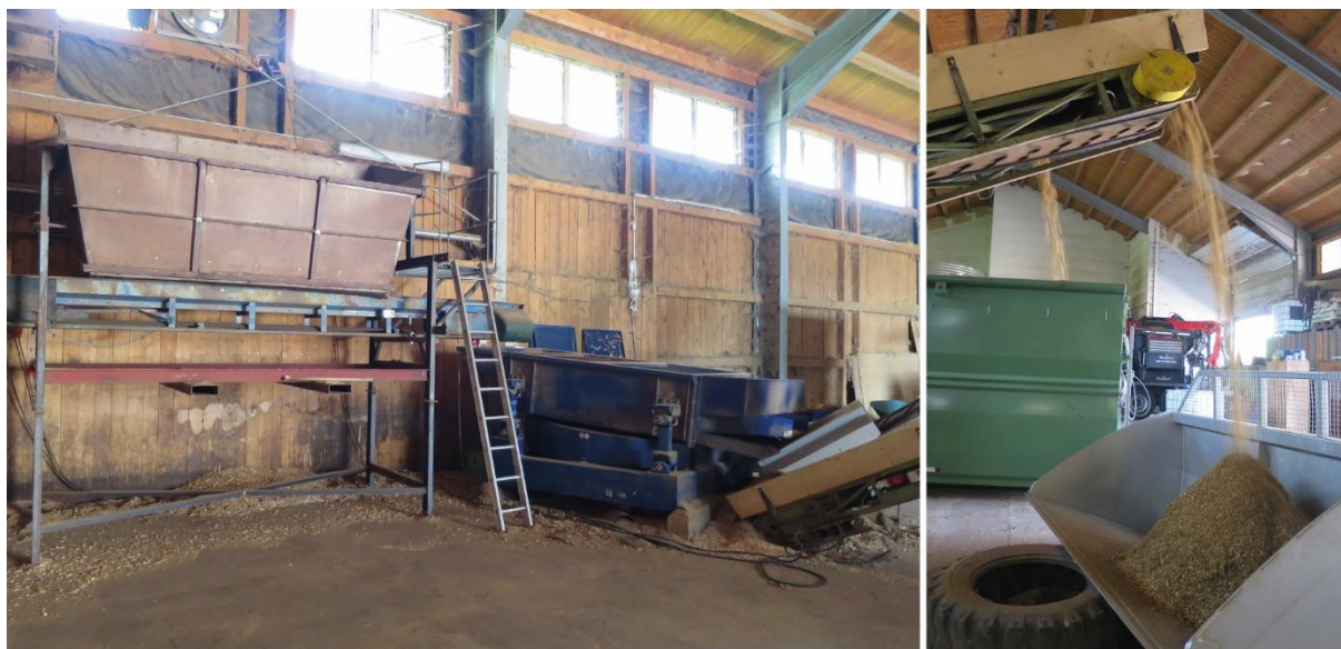
Abbildung 14: Verwendetes Schwingsieb zur Absiebung der Feinfraktion (Partikel < 10 mm)
