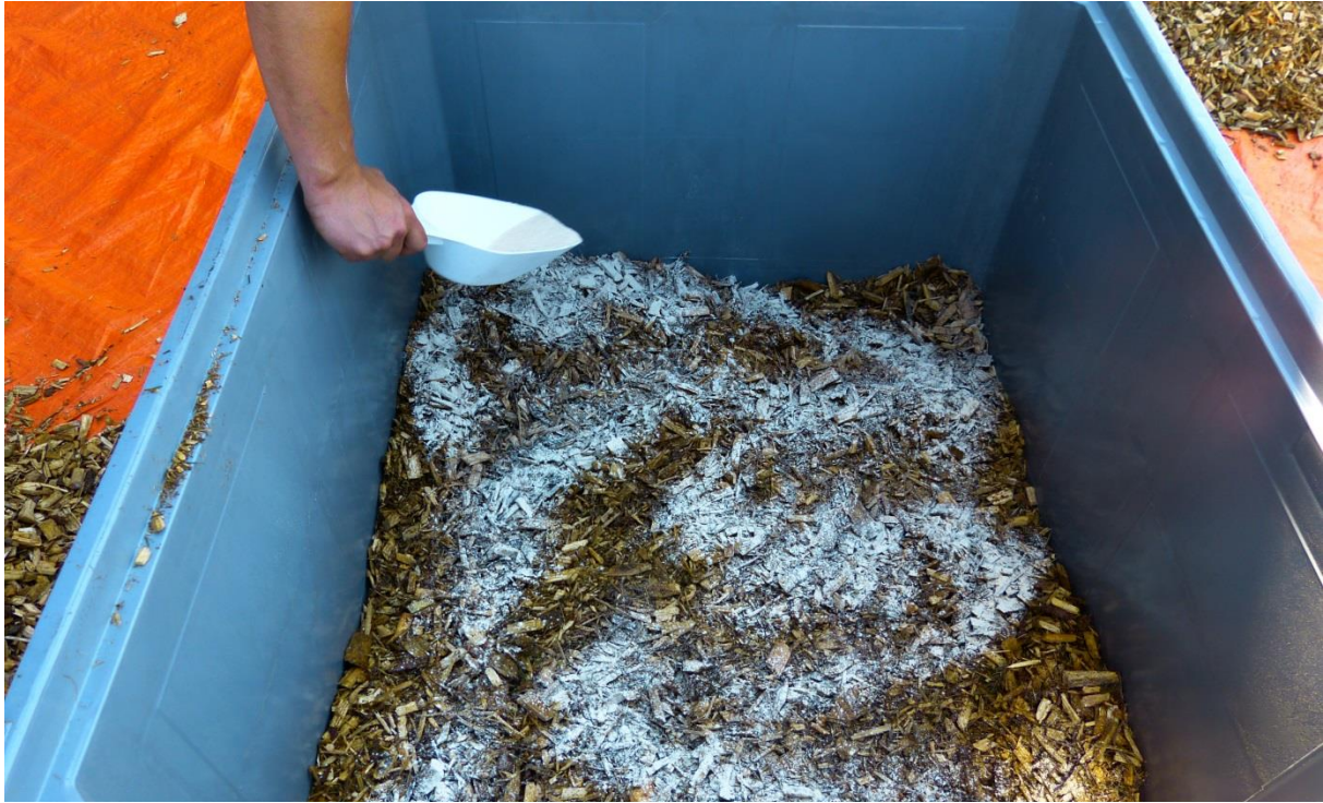
Abbildung 23: Manuelle Beimischung von \text{CaCO}_3 zu den Holzhackschnitzeln
