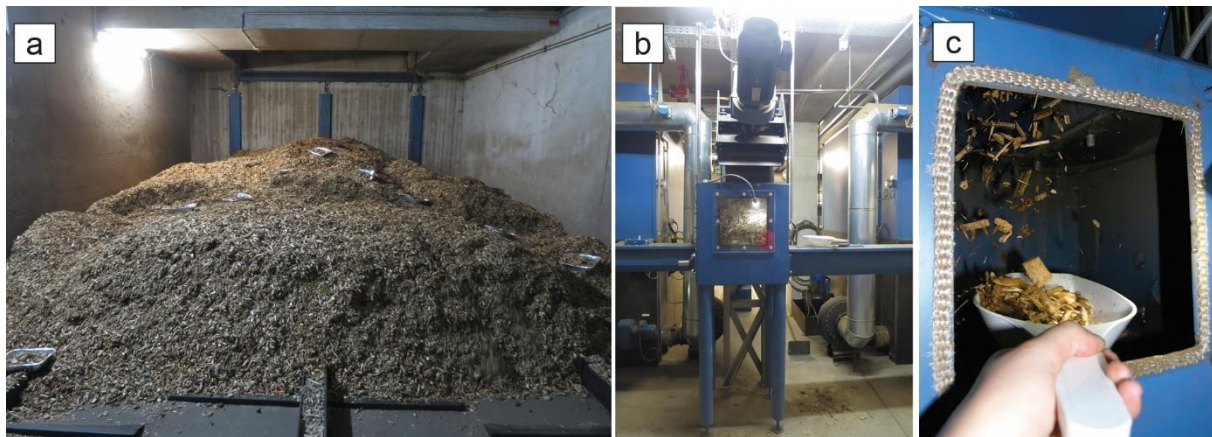
Abbildung 64: Probenahme im Bunker (a = an der Oberfläche im Bunker, b und c = vor der Feuerung)
