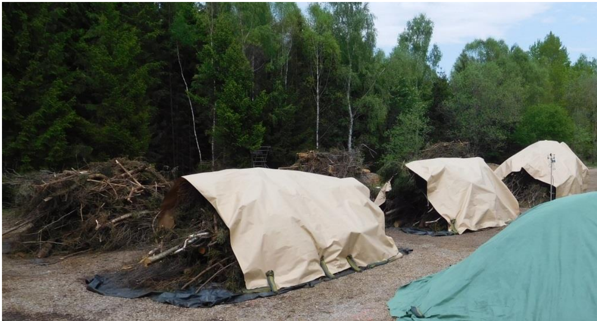
Abbildung 4: Lagerplatz in Putzbrunn nach dem Aufbau der Polterversuche. Jeweils drei Polter ohne Abdeckung und zum Vergleich drei Polter mit Abdeckung (Abdeckpapier: Walki Biomass Cover, Walki Group Oy)
