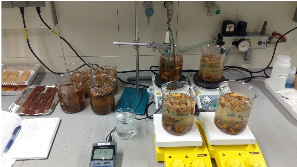
Abbildung 25: Bestimmung des pH-Werts nach DIN EN 15933 [37]
