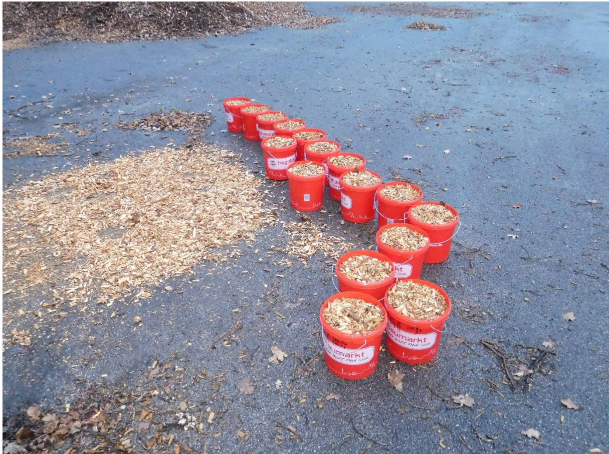
Abbildung 79: Holz hackschnitzelproben (hier des Sortiments Energierundholz) für die Untersuchung des lagerstabilen Wassergehalts nach Entnahme aus der Schüttung und Homogenisierung
