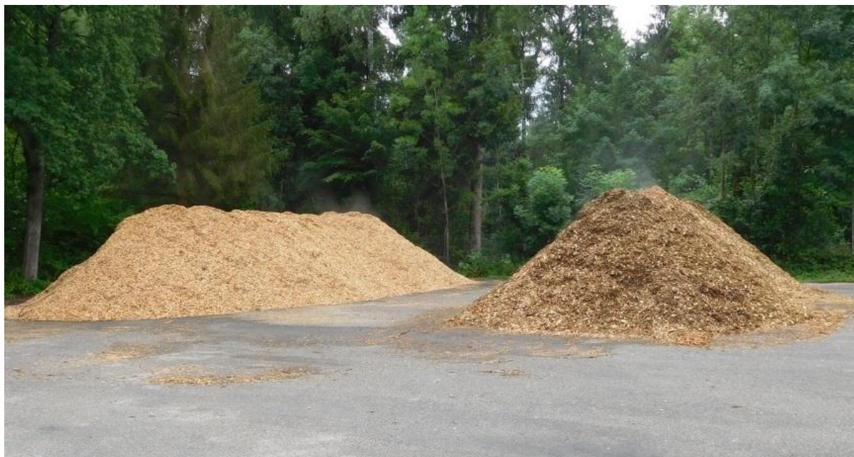
Abbildung 124: Holzhackschnitzelmieten aus Fichte (links: Energierundholz-HS, rechts: Waldrestholz-HS) zur Entnahme von Holzhackschnitzeln für die künstliche Beregnung
