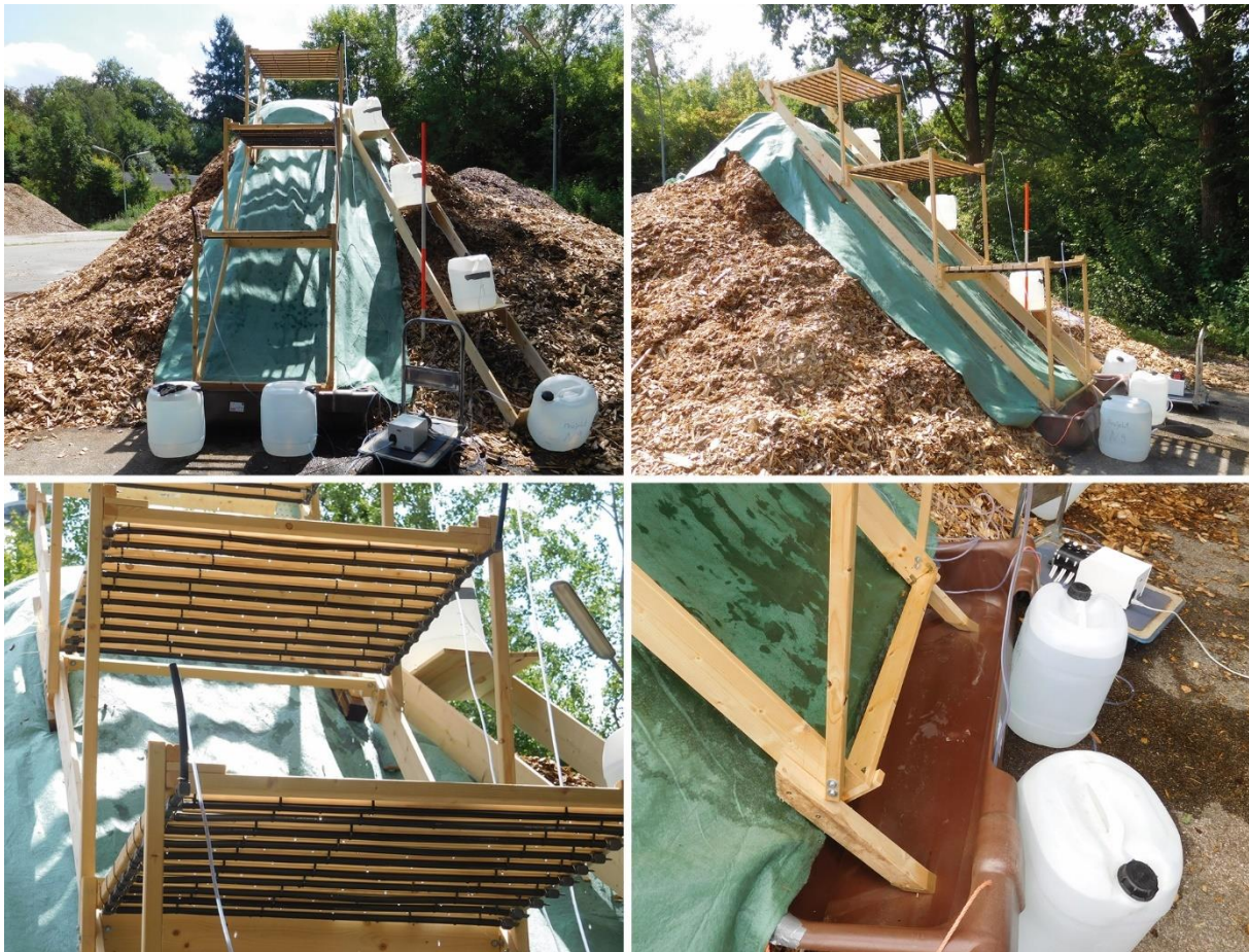
Abbildung 90: Versuchsaufbau zur künstlichen Beregnung des Vlieses auf einer ca. 3,5 m hohen Schüttung aus Energierundholzhackschnitzeln: Beregnungsgestell, bestehend aus drei 1 × 1 m großen Beregnungsgittern mit je 110 gleichmäßig verteilten Tropflöchern. Hilfsgestell für die drei Beregnungskanister mit VE-Wasser. Laborschlauchpumpe (auf dem Handwagen) für die konstante Förderung der eingestellten Wassermenge und Trog zum Auffangen des abgeleiteten Beregnungswassers. Die drei verschlossenen Kanister auf dem Boden dienten als Beschwerung.
