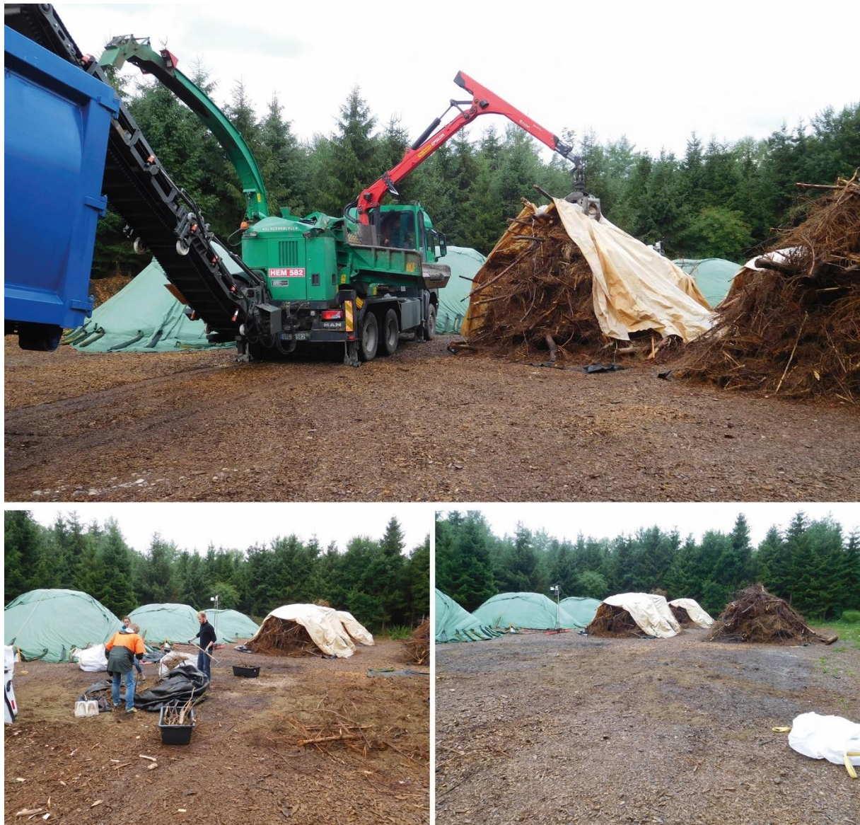
Abbildung 6: Lagerplatz in Putzbrunn während der ersten Probenahme. Oben: Hacken mitsamt Walki Biomass Cover. Unten links: Aufsammeln der abgefallenen bzw. liegen gebliebenen Biomasse für separates Verwiegen. Unten rechts: „gesäuberter“ Lagerplatz nach der ersten Probenahme. Das Verfahren der Probenahme erfolgte somit analog zu dem Vorgehen im bereits abgeschlossenen Projekt [60].
