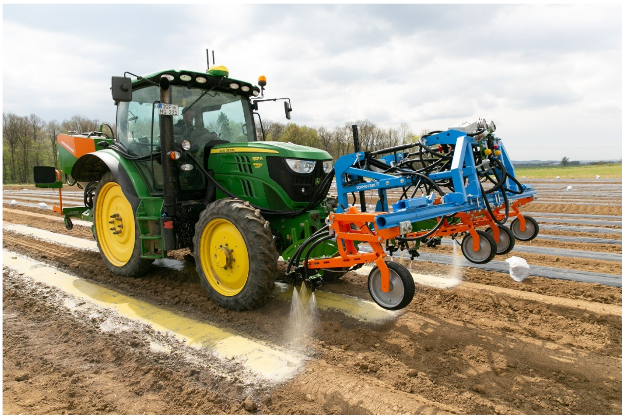
Abbildung 65: Applikation des Mulchmaterials in 3 mm Schichtdicke als Folienersatz in drei Bahnen
