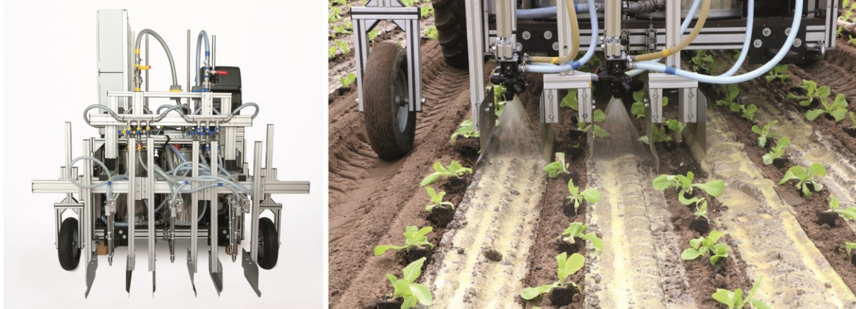
Abbildung 2: Applikationsgerät SAM für Reihenkulturen in der Rückansicht (links), SAM im Feldeinsatz beim Ausbringen von Mulchmaterial zwischen Kopfsalatreihen (rechts)
