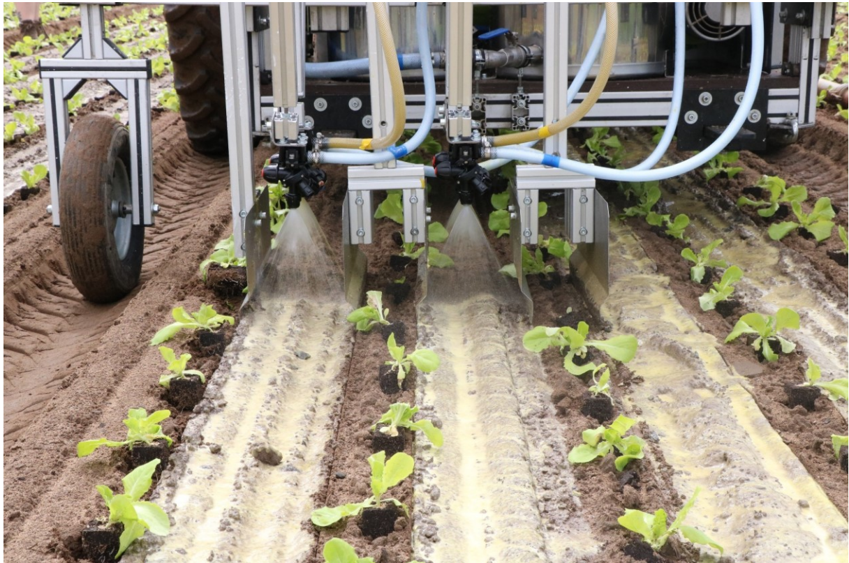
Abbildung 28: Ausbringung des spritzbaren Zwei-Komponenten-Mulchmaterials auf Basis Nachwachsender Rohstoffe zwischen Kopfsalatreihen mit dem Applikationsgerät SAM
