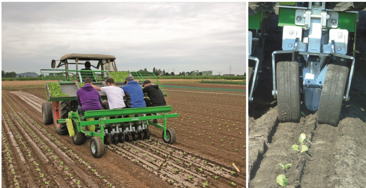
Abbildung 7: Pflanzmaschine Hortech OVER (links); Detailaufnahme des Pflanzaggregats mit geöffnetem Pflanzbecher beim Ablegen der Salatpflanze und Andruckrollen (rechts)
