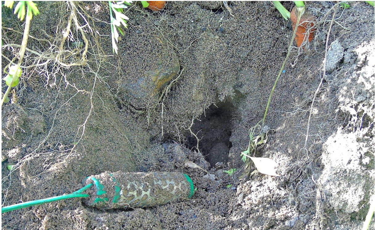
Abbildung 10: Feuchtesensor der Marke Watermark im Karottendammbaum nach dem Ausgraben
