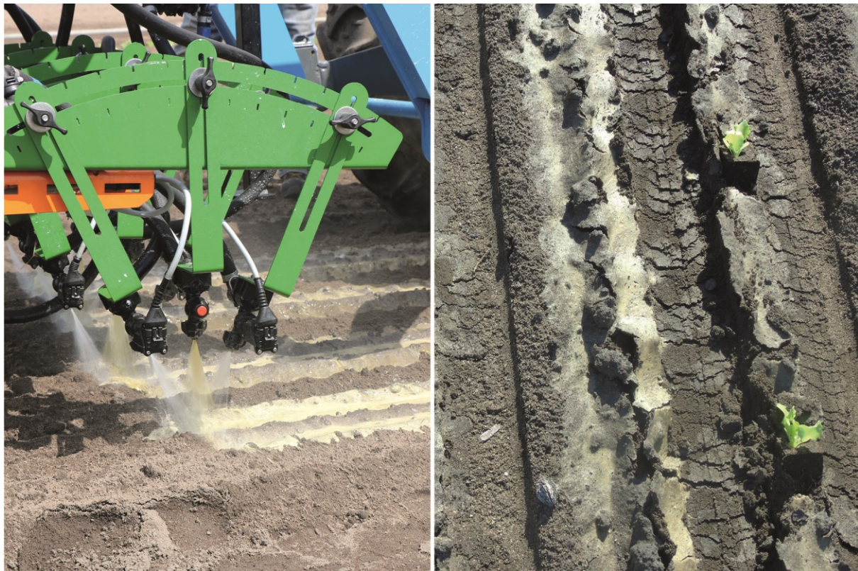
Abbildung 36: Ungleichmäßige Schichtdicke des Mulchmaterials als Folge der Bodenbearbeitung mit einer Prismenwalze (links) und ungleichmäßige Höhenablage der Salatjungpflanzen in eine durch zu tief eingestellte Andruckrollen zerstörte Mulchschicht (rechts)
