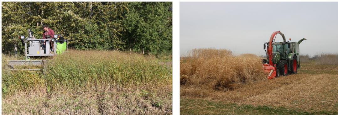
Abbildung 2: Ernte von Switchgras im Sommer mit einer Parzellenerntemaschine bei einem TS-Gehalt von rund 28 % und nach dem Winter bei einem TS-Gehalt von über 85 % für die thermische Verwertung
