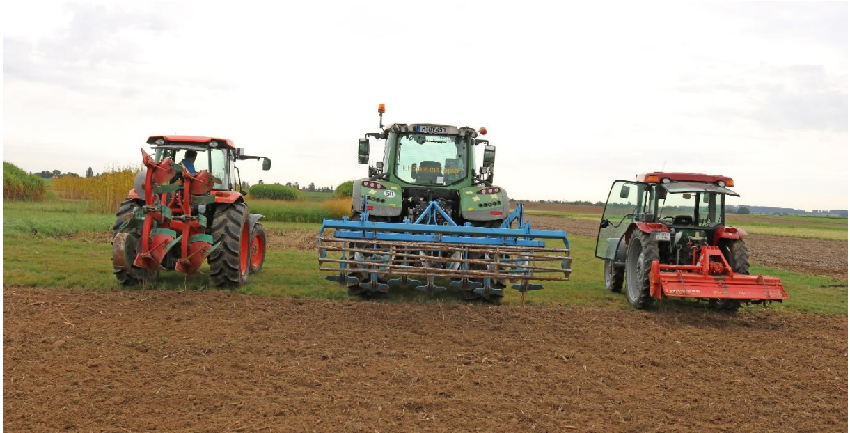
Abbildung 3: In den Umbruchversuchen eingesetzte Bodenbearbeitungsgeräte (von links nach rechts: Pflug, Grubber, Fräse)
