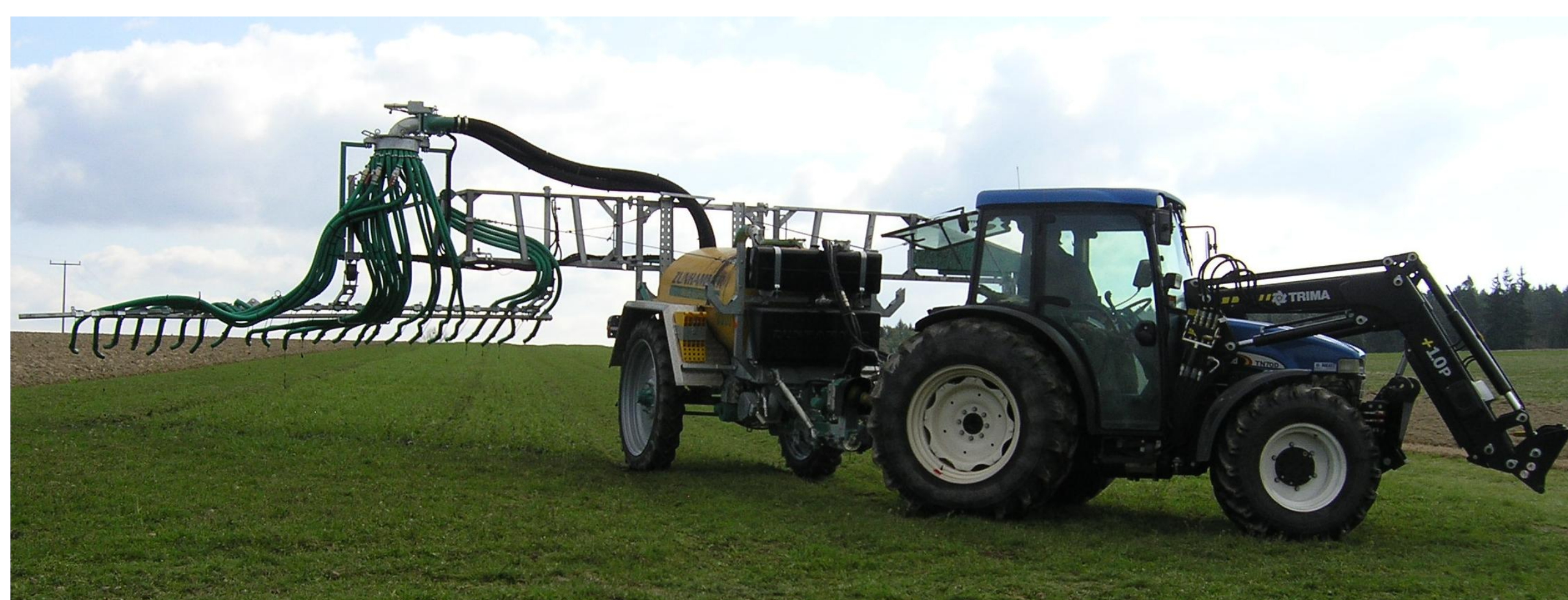
Abb. 1: Bodennahe Gärrest-Ausbringung mit Schleppschräufen
