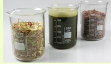
Bioethanol kann entweder aus den Körnern oder aus den zuckerhaltigen Halmen (wie bei Zuckerrohr) gewonnen werden (von links nach rechts: Häckselgut, Presssaft und Bagasse).
