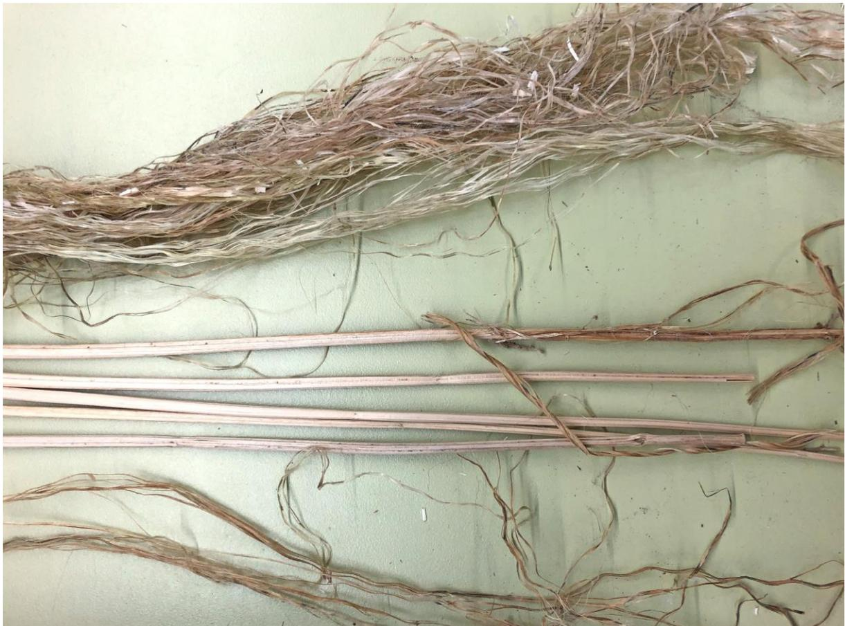
Abbildung 90: Auftrennung der Winterhanfstängel in Fasern und den holzigen Teil ohne Brechen
