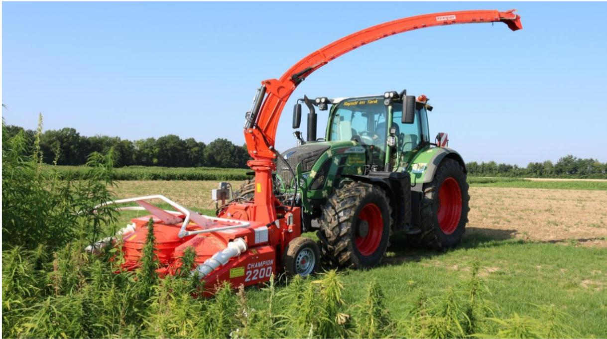
Abbildung 7: Feldhäcksler der Firma Kemper am Standort TFZ
