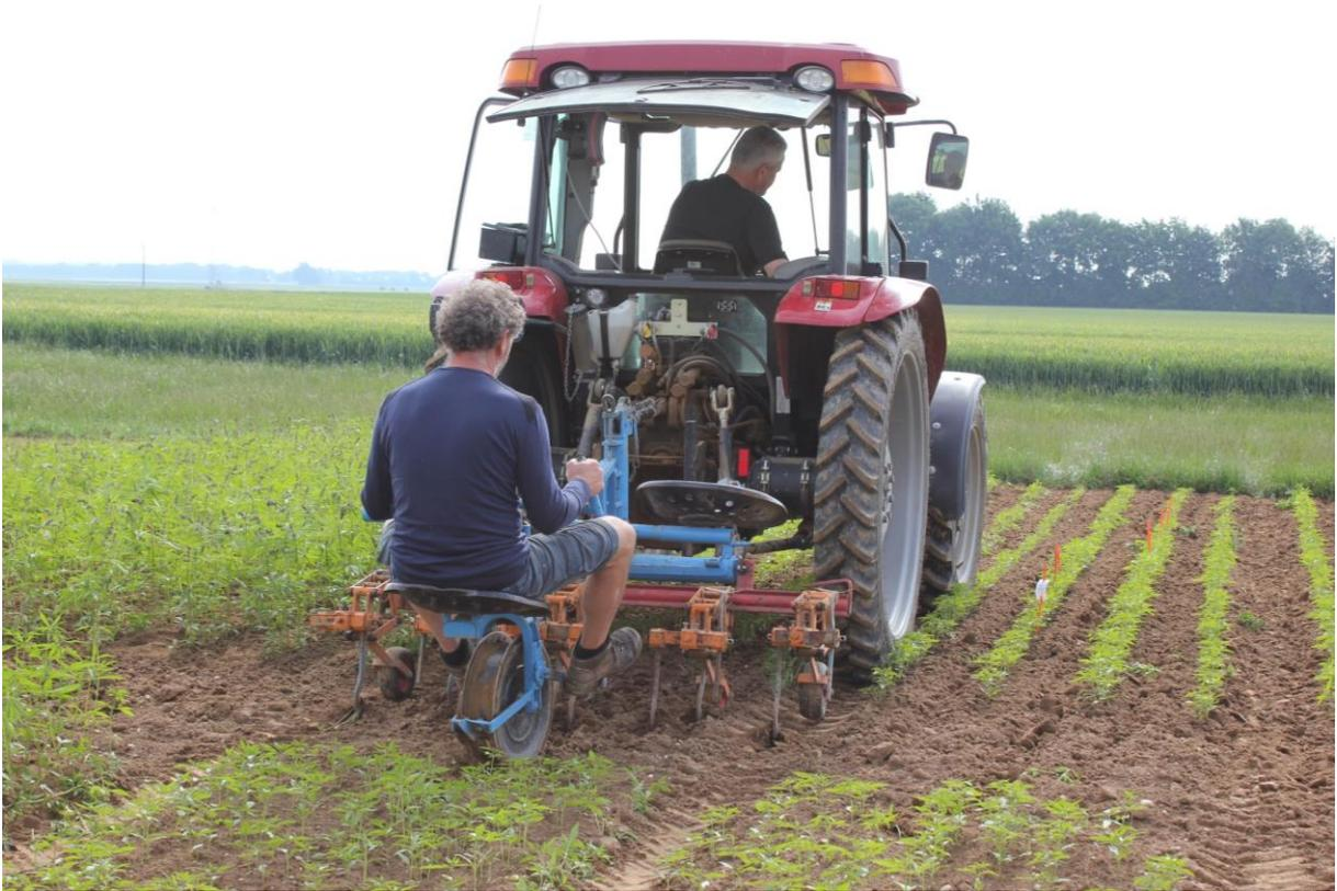
Abbildung 5: Hackgerät der Firma Rau bei Hackmaßnahmen im Hanf
