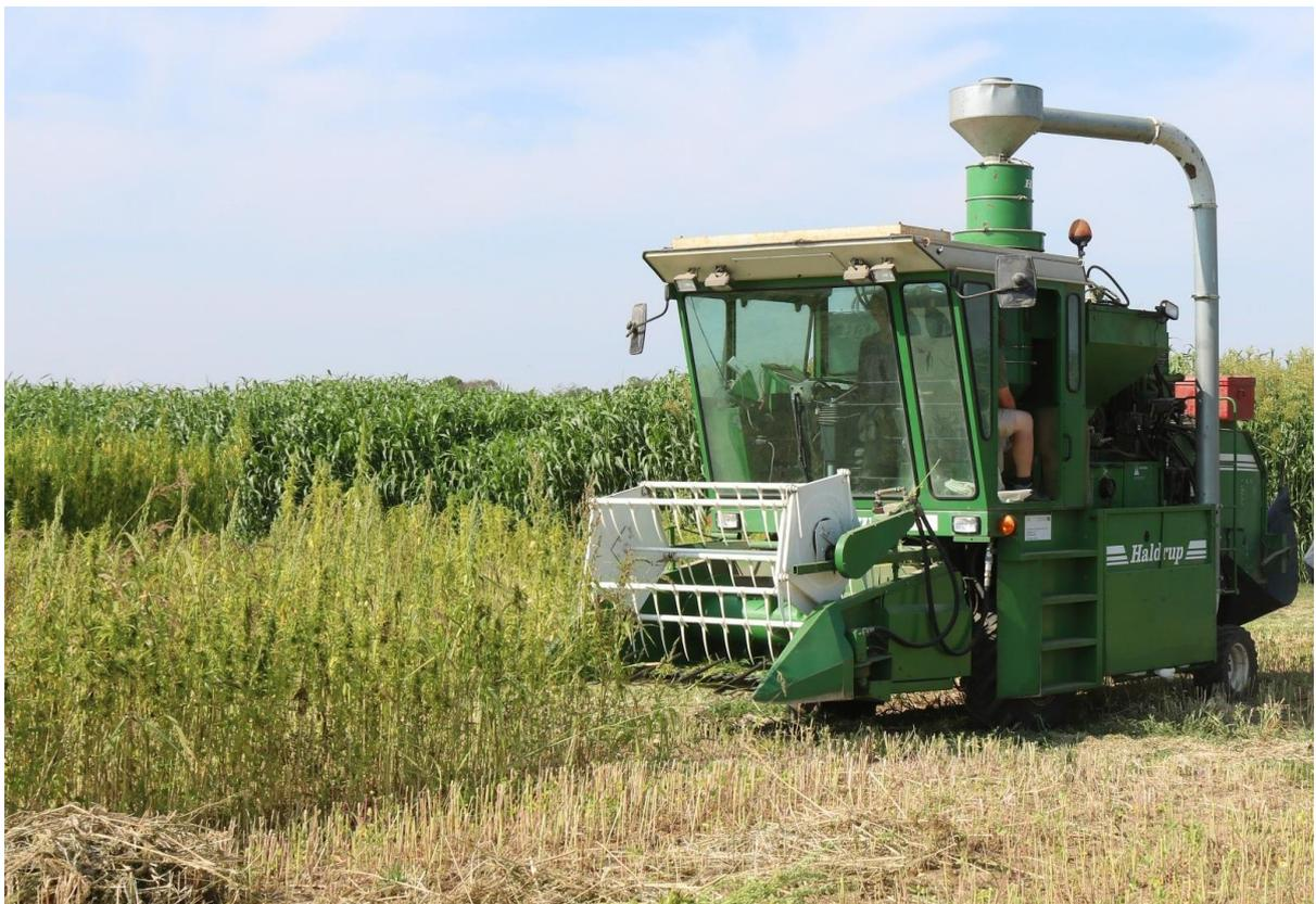
Abbildung 6: Parzellenmähdrescher am Standort TFZ bei der Körnerhanfernte
