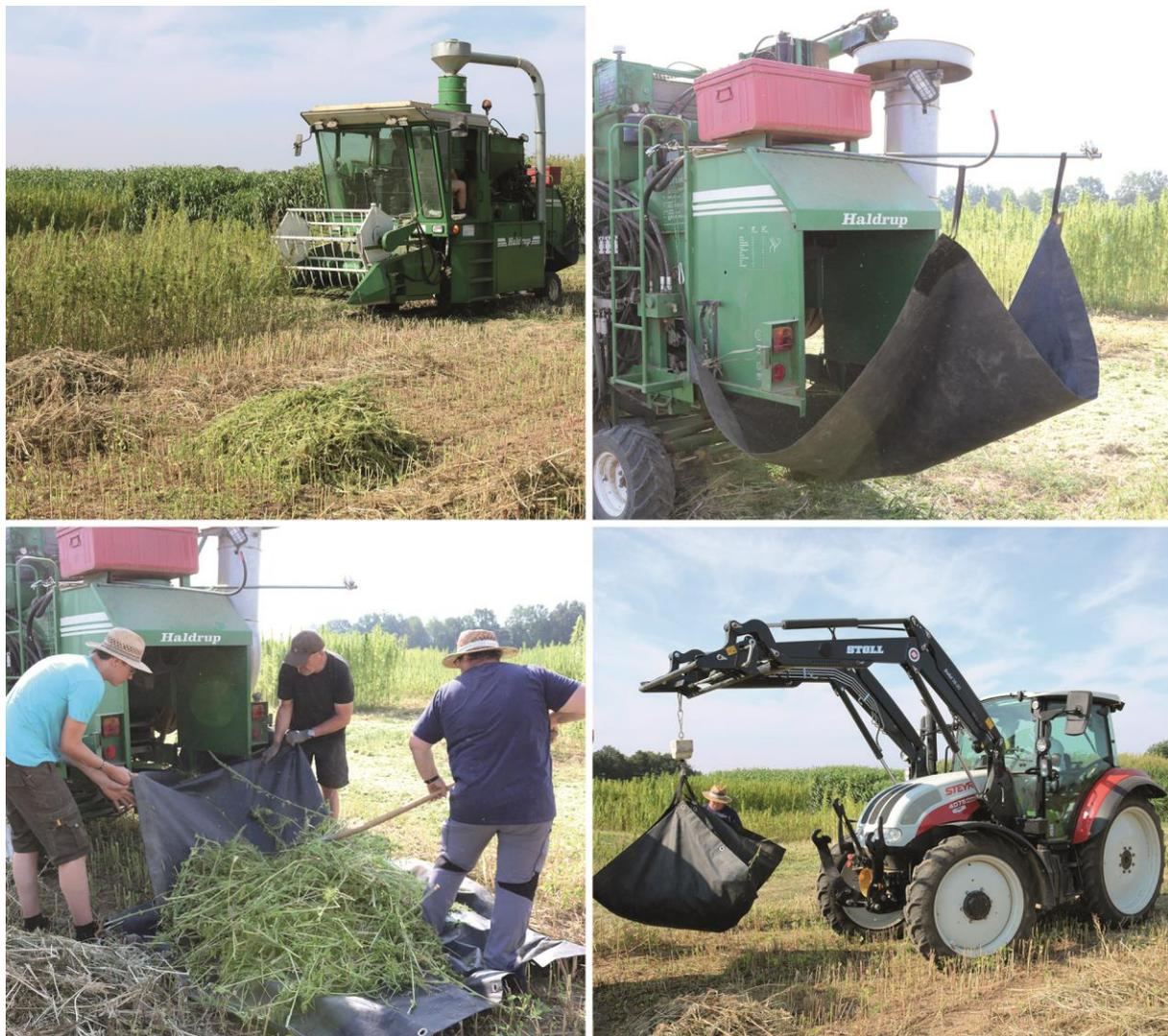
Abbildung 10: Ernte Körnerhanf – oben links: Parzellenmähdrescher; rechts: Auffangvorrichtung für das Stroh; unten links: Umlagern des Strohs auf die Plane zum Wiegen; rechts: Verwiegen des Strohs mittels Waage am Frontlader
