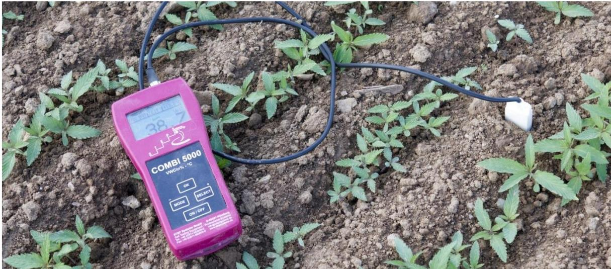
Abbildung 14: Bodenfeuchtemessgerät MST 5000 bei der Messung der Bodenfeuchte in einem Faserhanfbestand
