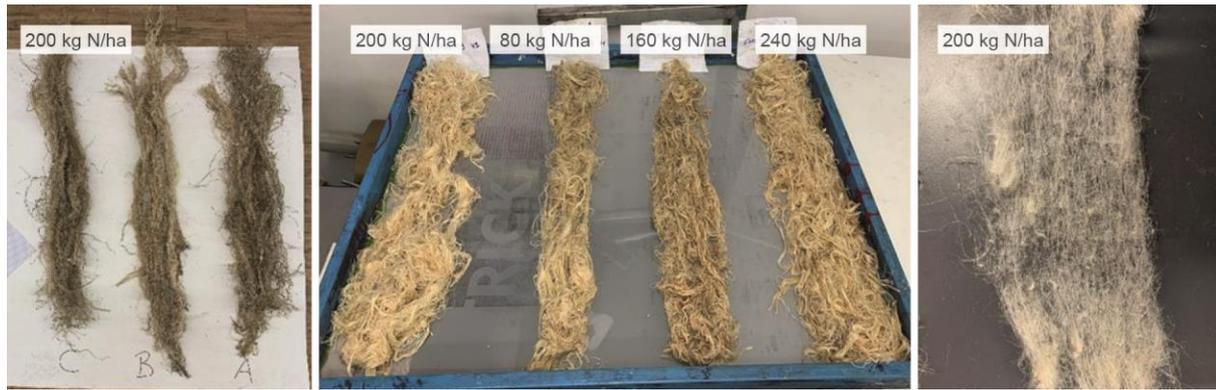
Abbildung 44: Hanffasern nach mechanischem Faseraufschluss der Stängelabschnitte (links) sowie chemischem Faseraufschluss der verschiedenen Varianten (Mitte), optische Beurteilung der Faserfeinheit (rechts)
