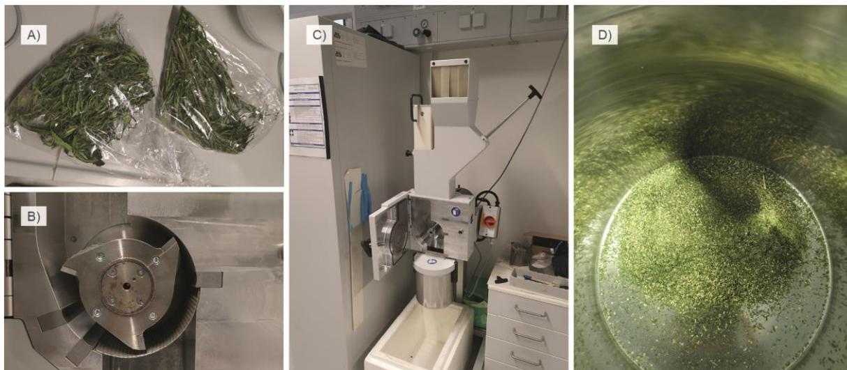
Abbildung 65: Getrocknete Proben in Crisp Bags (A); Schneidwerkzeug (B); Schneidmühle Fritsch SM 100 (C); gemahlenes Probenmaterial  $< 1$  mm (D)
