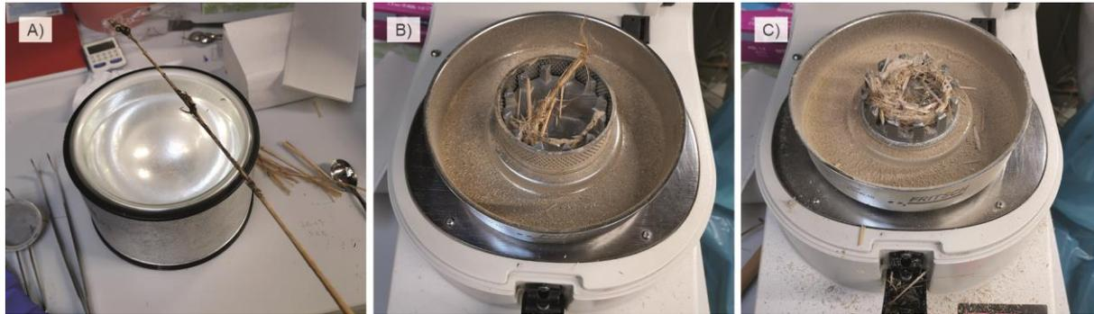
Abbildung 64: Versuch des Mahlens von Hanfstroh mittels Pulverisette 14 mit Vorbehandlung in flüssigem Stickstoff und verschiedenen Geschwindigkeiten (B: 8000 rpm, C: 20 000 rpm)
