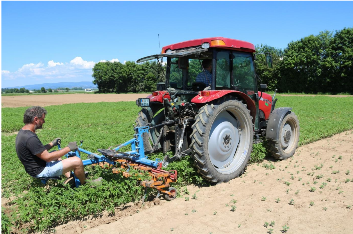
Abbildung 25: Hacken im Hanfbestand mit manueller Steuerung im Heckanbau, 03.06.2019
