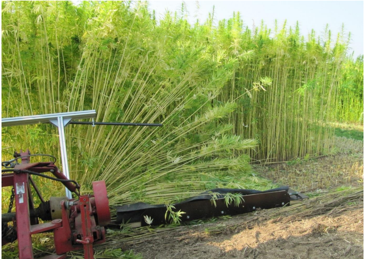
Abbildung 29: Auffangen der geschnittenen Pflanzen mit Auffangwanne
