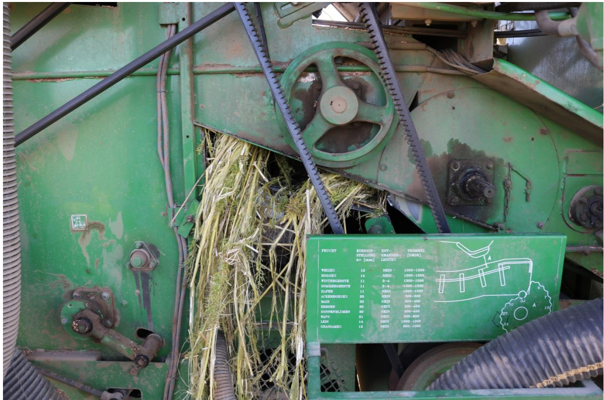
Abbildung 48: Verstopfte Dreschtrummel durch faseriges, langes Hanfstroh
