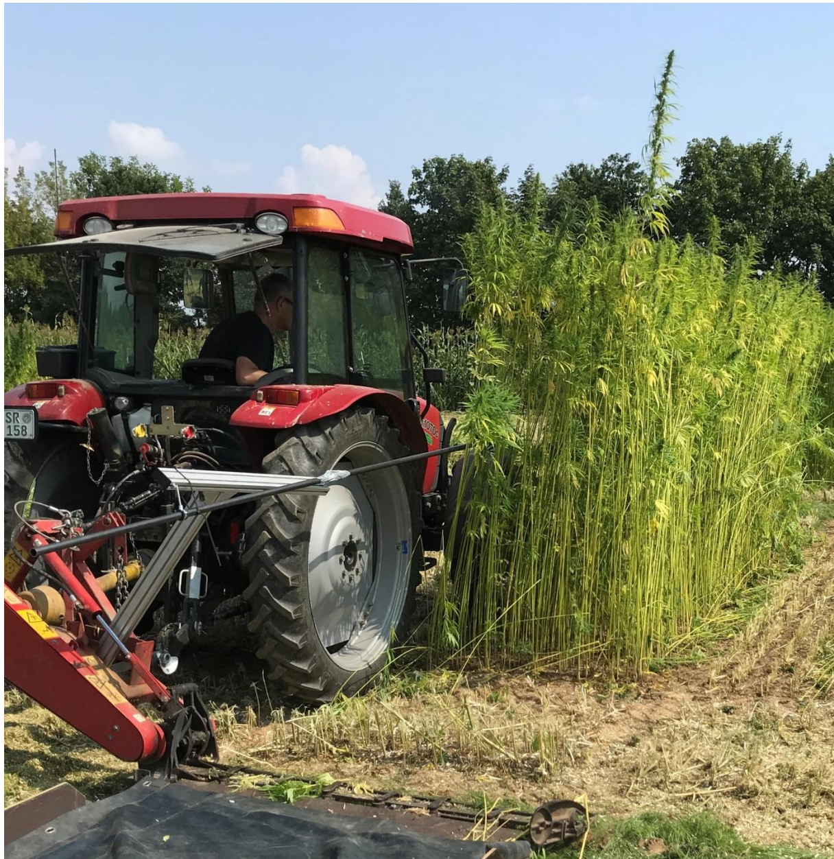
Abbildung 28: Schnitt der Kernparzelle mit Balkenmäher im Heckanbau
