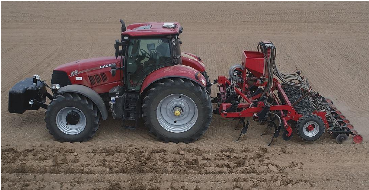
Abbildung 20: Prototyp Sämaschine Focus, Firma Horsch
