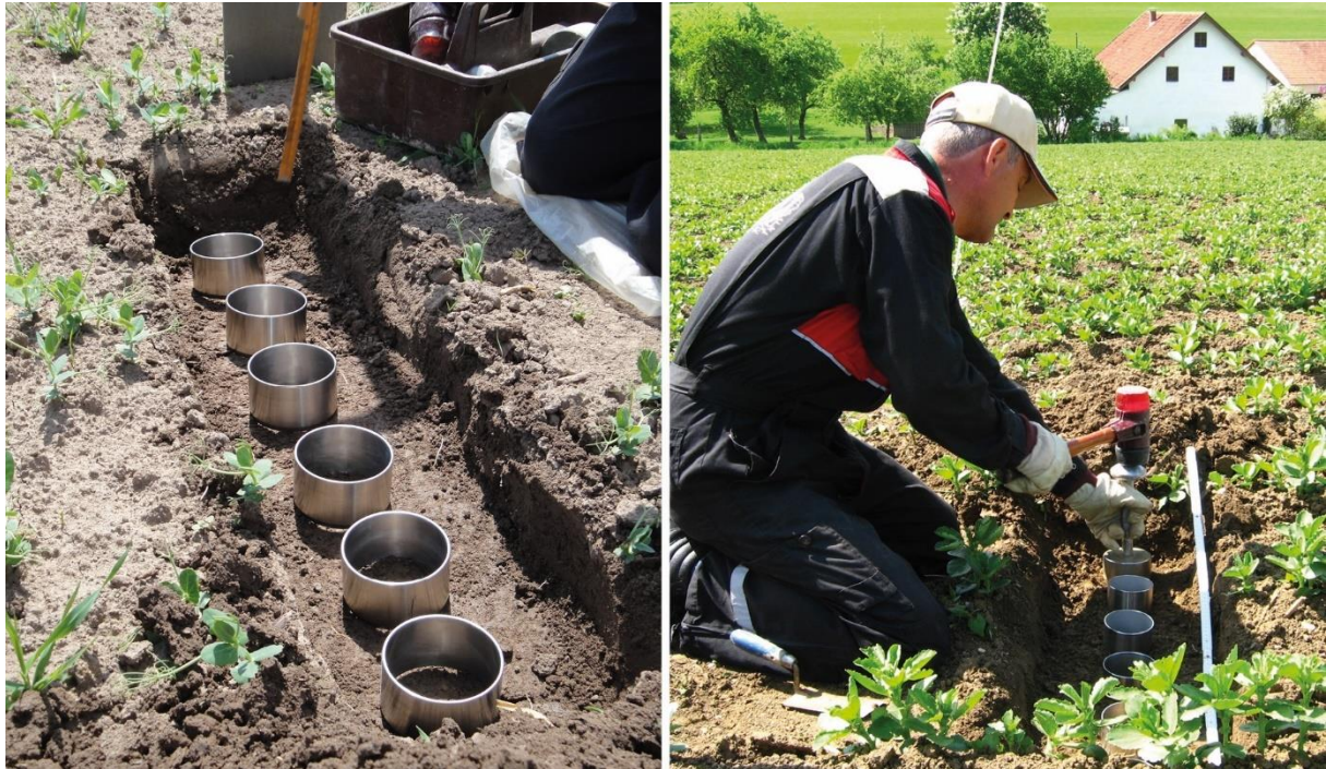
Abbildung 9: Probenahme mit Stechzylindern zur Bestimmung der bodenphysikalischen Parameter; je Beprobungstiefe sechs Stechzylinder als Wiederholung horizontal nebeneinander (links); Durchführung der Probenahme mit Einschlagen der Stechzylinder und anschließendem sorgfältigen Ausgraben (rechts)
