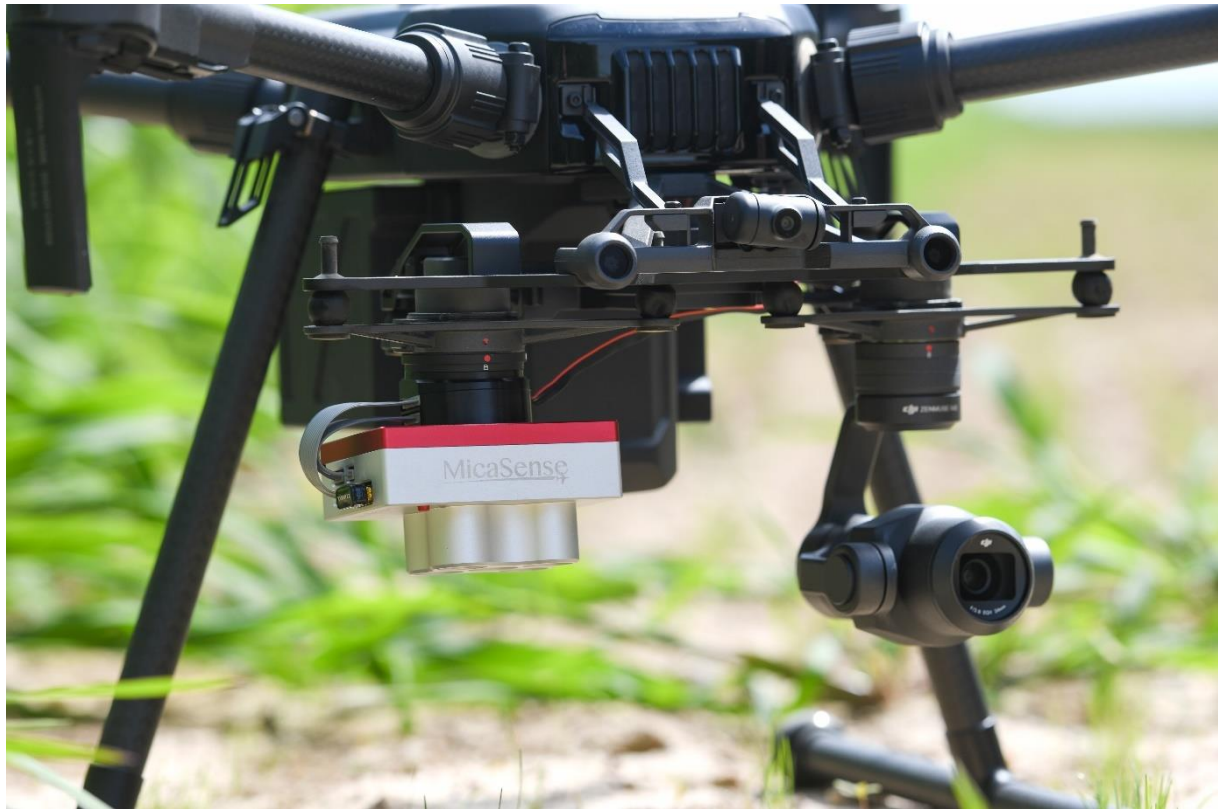
Abbildung 8: Versuchsdrohne mit Multispektralsensor (links) und RGB-Sensor (rechts)
