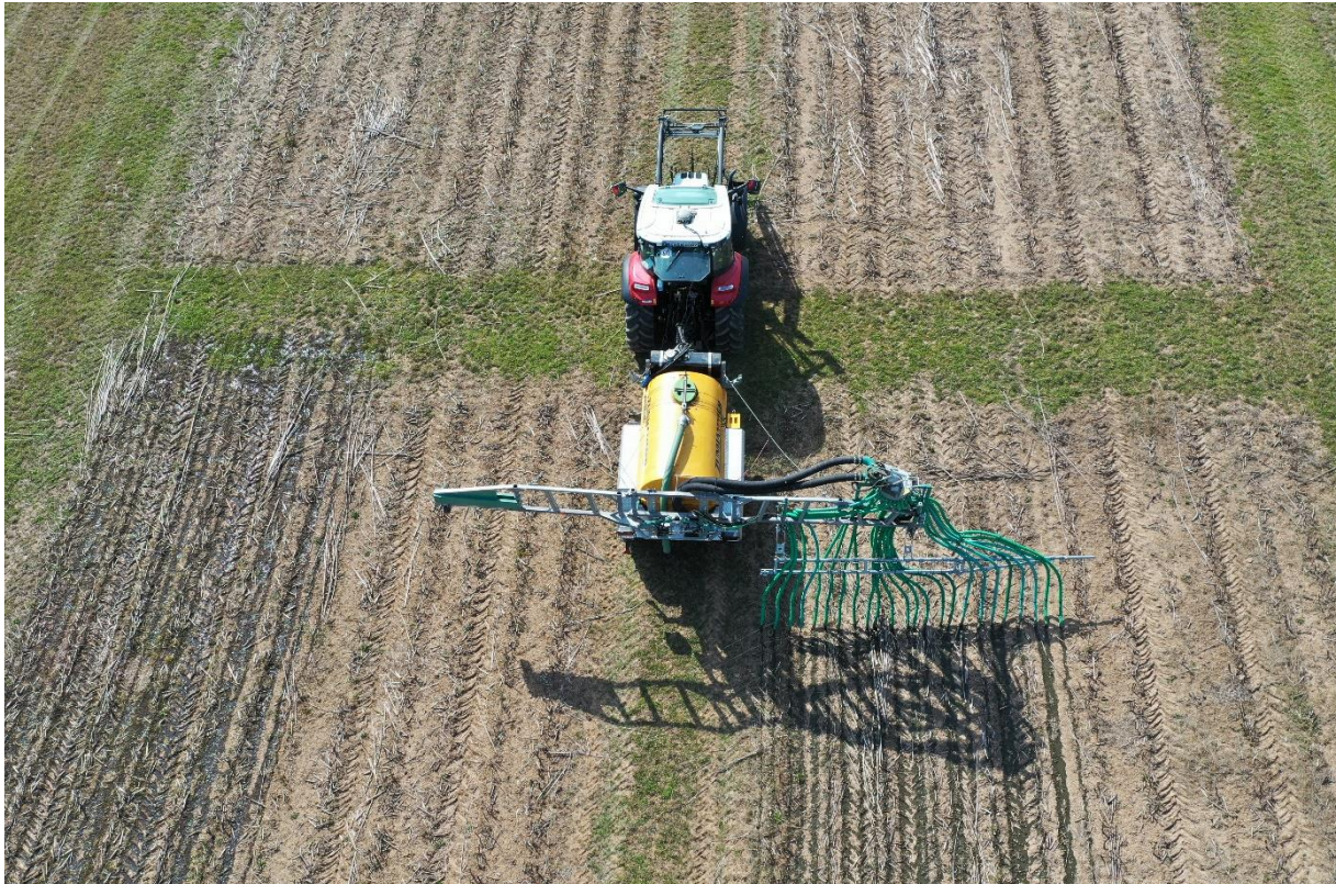
Abbildung 4: Gärrestausbringung auf die Versuchspartzen mit einem Parzellengülle-fass mit seitlich geführtem Schleppschlauchverteiler im Versuch zur Optimierung der N-Düngung von Durchwachsener Silphie Ende März 2021
