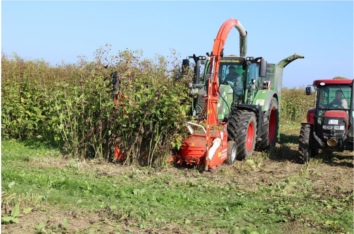
Abbildung 7: Ertragserfassung der Ernteparzellen mit einem Häcksler mit seitlichen Trennmessern nach dem Entfernen der Stirnränder im Versuchsjahr 2021
