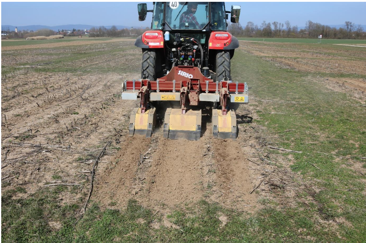
Abbildung 6: Bearbeitung der Bereiche zwischen den Silphiereihen mit einer Reihenfräse zur Unkrautbekämpfung
