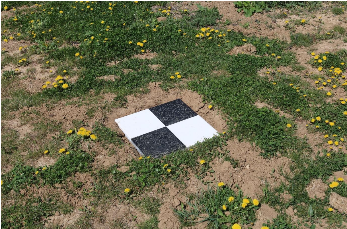
Abbildung 11: Einer von vier Ground Control Points zur Georeferenzierung nach dessen Platzierung Anfang April 2020
