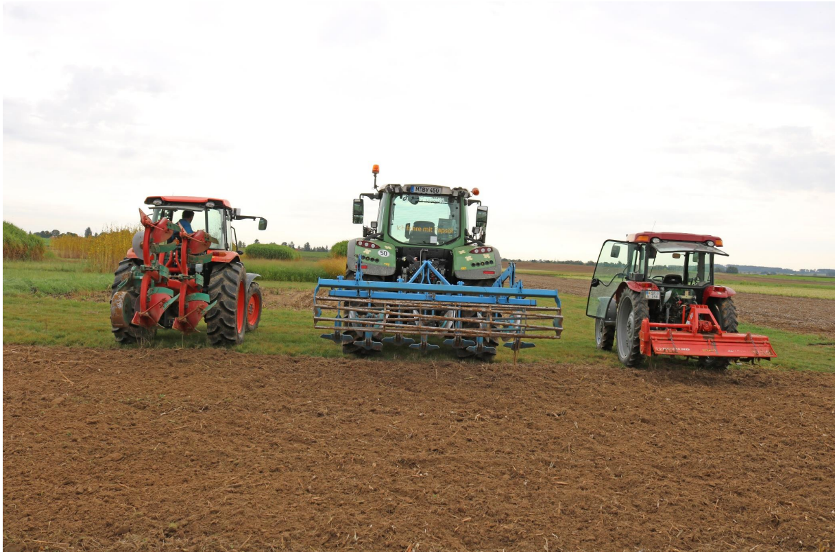
Abbildung 15: In den Umbruchversuchen eingesetzte Bodenbearbeitungsgeräte (von links nach rechts: Pflug, Grubber, Fräse)
