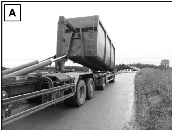
Abbildung 32: Umladen eines leeren Containers vom abgestellten Anhänger auf den Motorwagen (A) und befüllte Container am Umladeplatz (B)
