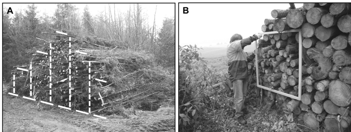
Abbildung 99: Unterteilung der Stirnseite eines Waldrestholzpolters zur Ermittlung der mittleren Höhe im Sektionsverfahren (A) (die vertikalen Striche unterteilen das Polter in 1 m breite Abschnitte) und Vermessung der Kronenfüße mit Hilfe eines Holzrahmens mit 1 × 1 m Seitenlänge (B)
