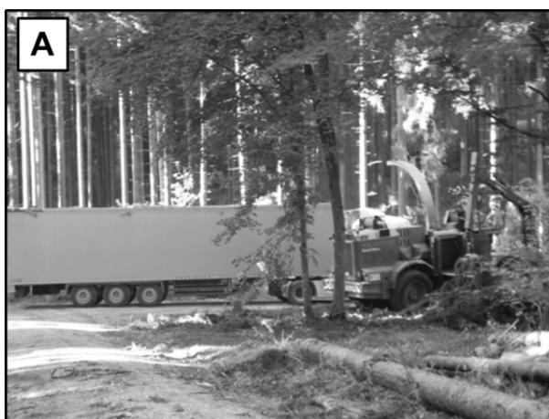
Abbildung 33: Aufstellung eines Schubboden-Lkw bei ausreichender Wegebreite parallel zum Hacker (A) und rückwärts am Hacker (B)
