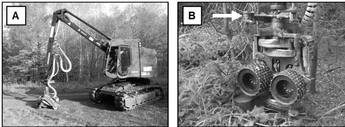
Abbildung 37: Der eingesetzte Raupenharvester Neuson Ecotec 132 HVT (A). Oberhalb der Entastungsmesser des Logmax-5000D-Harvester-Kopfs ist die nachgerüstete Sammeleinheit zu erkennen (B, markiert mit Pfeil).
