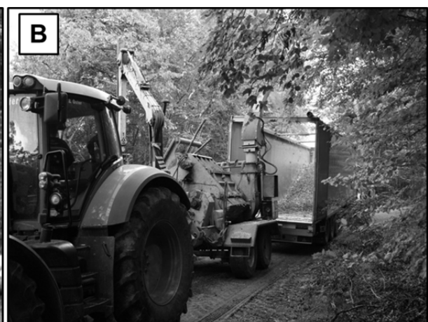
Abbildung 33: Aufstellung eines Schubboden-Lkw bei ausreichender Wegebreite parallel zum Hacker (A) und rückwärts am Hacker (B)
