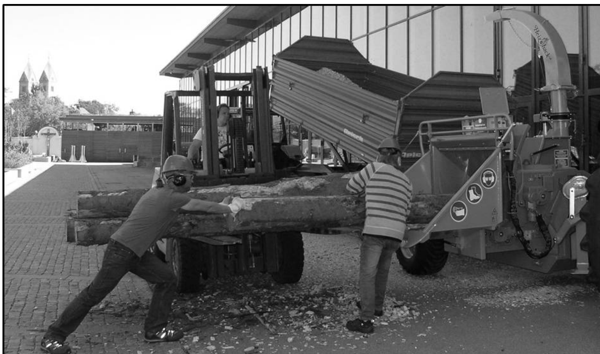
Abbildung 73: Semimanuelle Beschickung der zapfwellenbetriebenen Hacker bei den stationären Versuchen am TFZ
