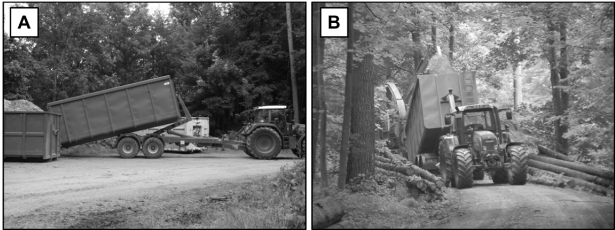
Abbildung 35: Hackschnitzelshuttle im Einsatz bei der Aufnahme eines leeren Containers am Umladeplatz (A) und bei der Befüllung am Hacker (B)
