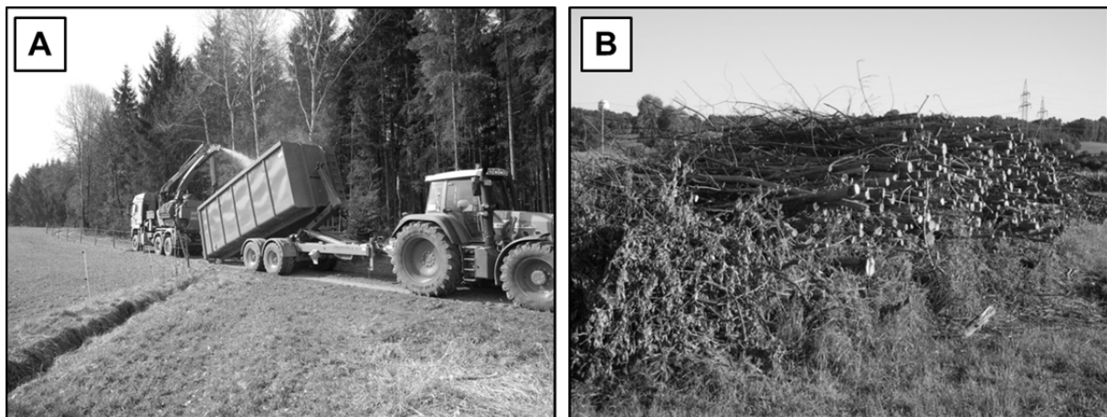
Abbildung 4: Hackschnitzelshuttle im Einsatz (A), Vortrocknen eines Hackholzpolters auf einer Wiese (B)
