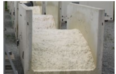
Miniature bunker silos
